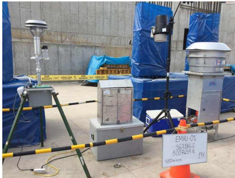
Estación de Calidad de Aire EMHU-01. Agosto 2018.
