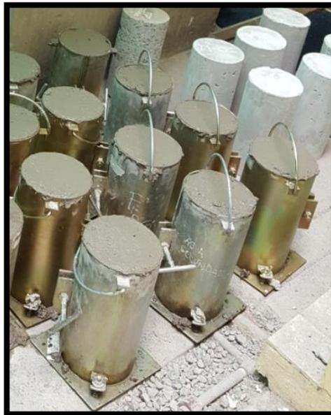
**Figura 17.** Enrase de las probetas
