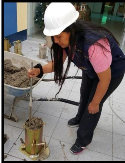
**Figura 16.** Varillado compactado de concreto
