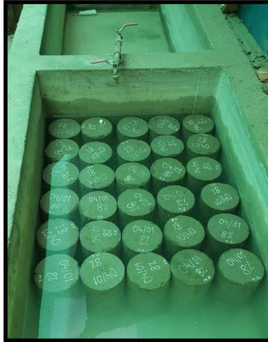
**Figura 18.** Curado de probetas de concreto
