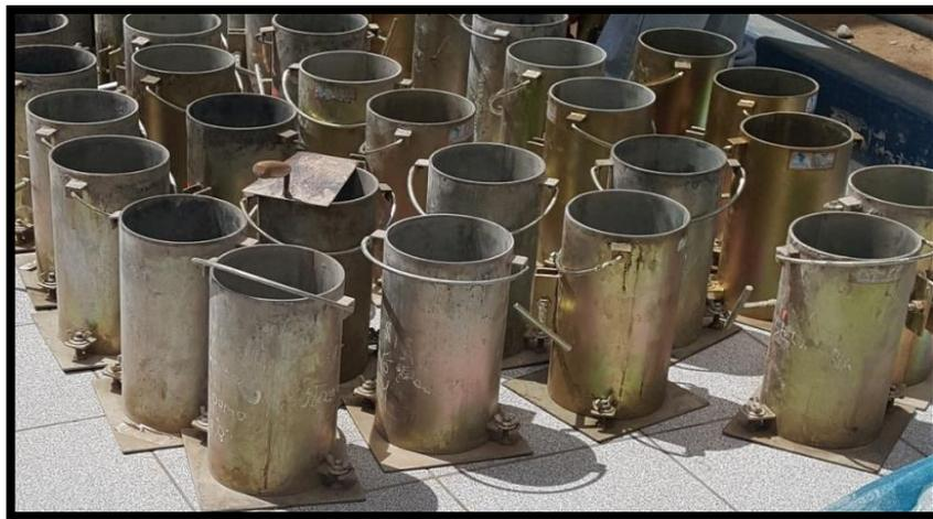
**Figura15.** Moldes de probetas.
