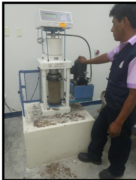
Imagen 25 Rotura de Briquetas de concreto fluido
