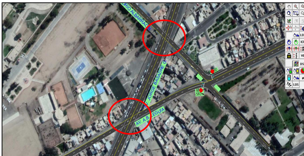
FIGURA N° 57: Deprimiendo la Av. Jorge Basadre G. se anula las intersecciones de la Av. Gregorio Albarracín y Av. A.B. Leguía, proyectado a 20 años. Propuesta de Mejora 3
