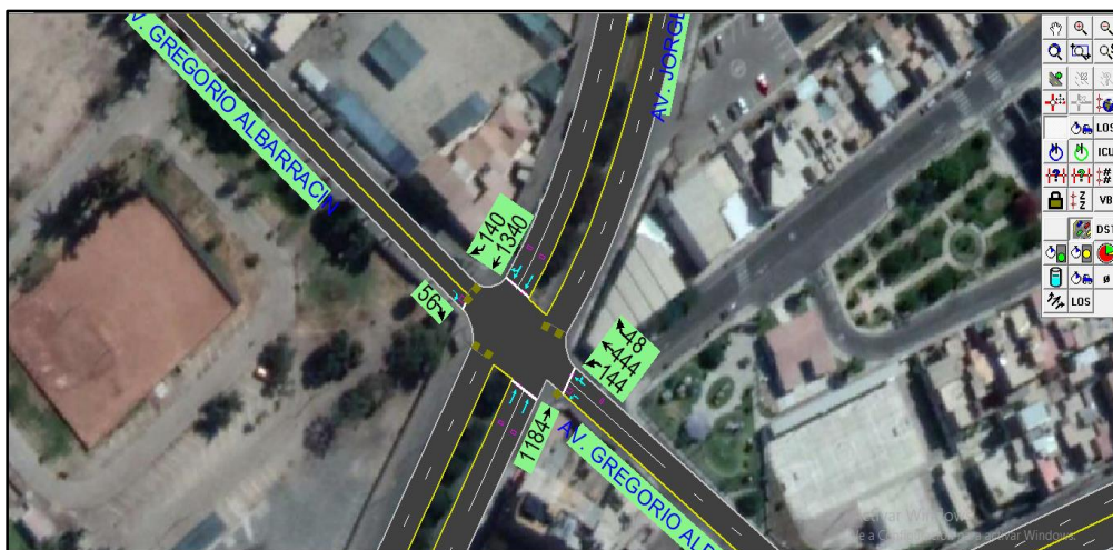
FIGURA N° 28: Ingreso de Flujos Vehiculares por Acceso y sentido de movimiento en la Intersección Av. G. Albarracín FUENTE: Programa Synchro V.8
