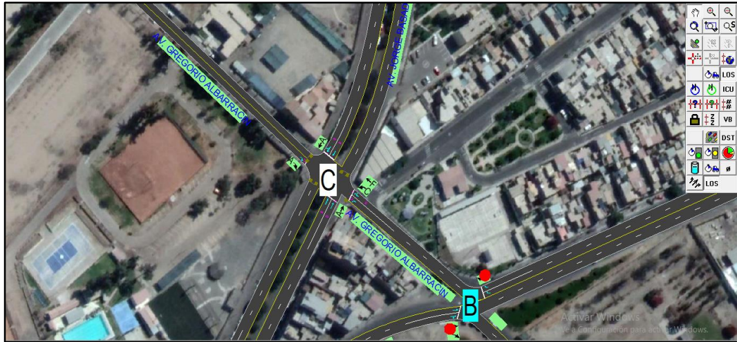
FIGURA N° 33: Nivel de Servicio por accesos y de la intersección Av. Gregorio Albarracín. FUENTE: Programa Synchro V.8
