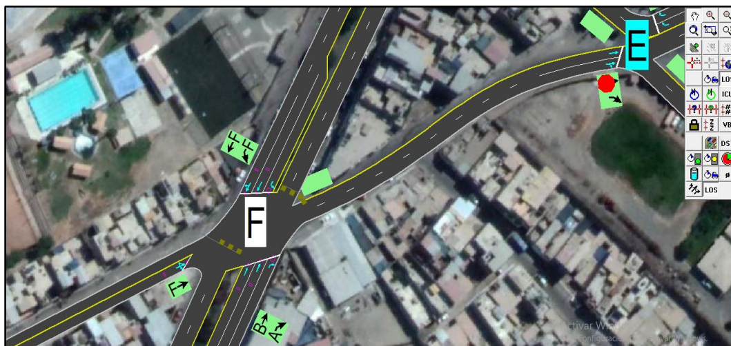
FIGURA N° 40: Nivel de Servicio por accesos y de la intersección, Av. A.B. Leguía FUENTE: Programa Synchro V.8
