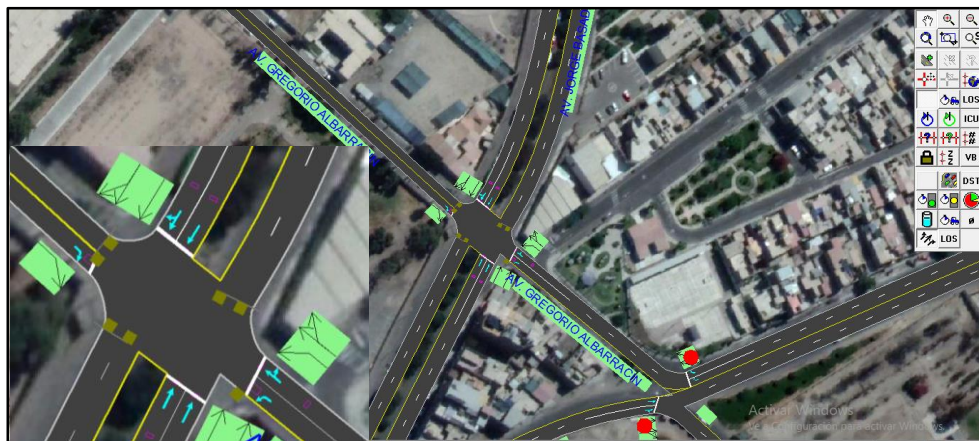
FIGURA N° 26: Ingreso de Carriles con respectivos Giros en la Intersección Av. G. Albarracín
