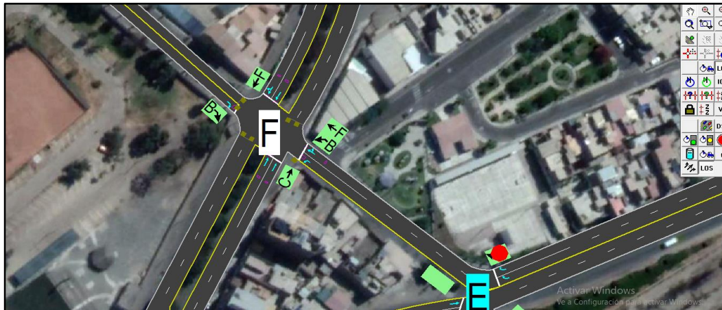
FIGURA N° 39: Nivel de Servicio por accesos y de la intersección, Av. Gregorio Albarracín
