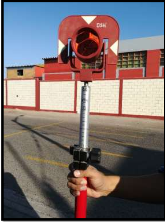
Ilustración 5: “Utilizamos el prisma con altura 1.60 m” Fuente: “Propia”
