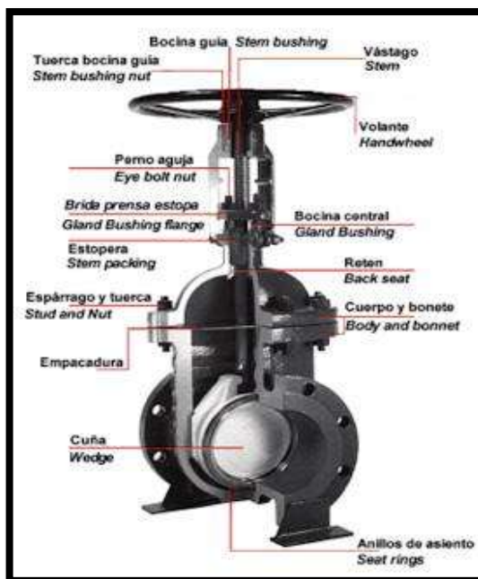
Ilustración 15 “Partes de una válvula de compuerta”
