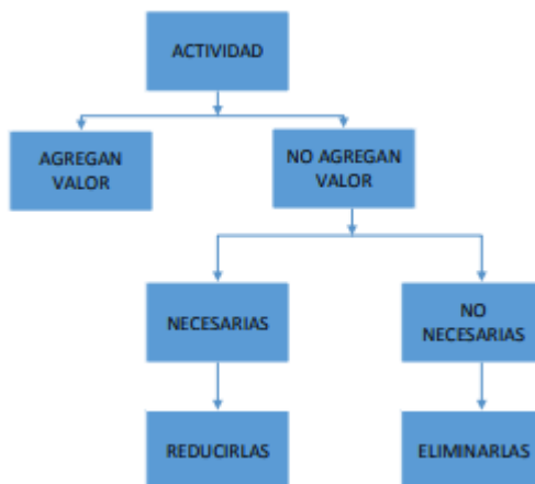
Figura 1. Clasificación de las Actividades según Lean Production (Fuente: Elaboración propia (adaptado de Guzmán, 2014))
