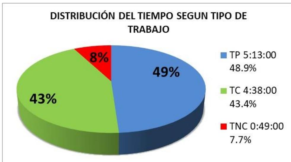
**Figura 4.7** Distribución del tiempo según tipo de trabajo para el proceso de Habilitación y colocación de acero corrugado en columnas con empalme tradicional. (Fuente: Elaboración propia)
