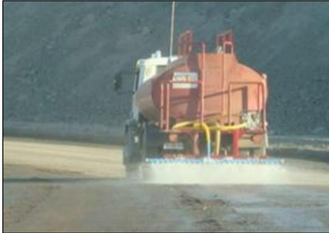
Figura N° 05: Riego con cloruro de magnesio y/o bischofita.
