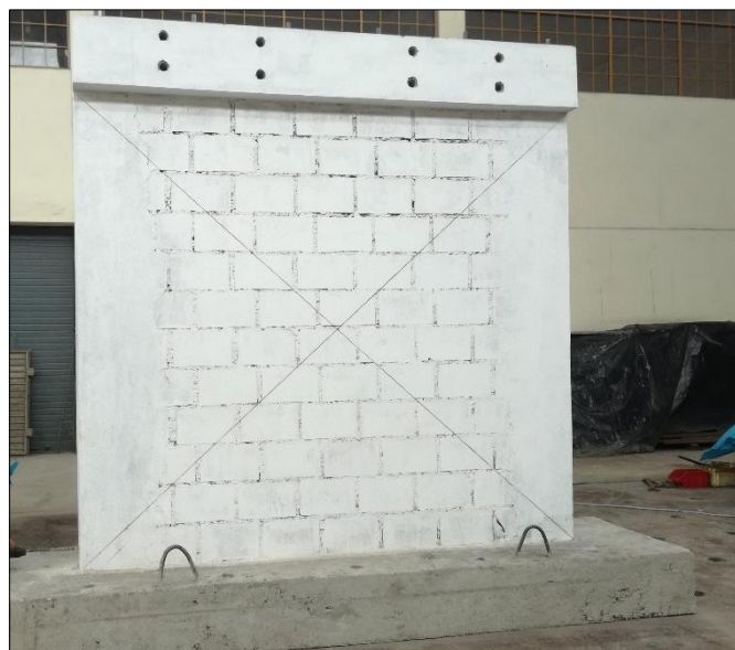
Fig. 3- 13: Muros de albañilería listo para ensayar.
