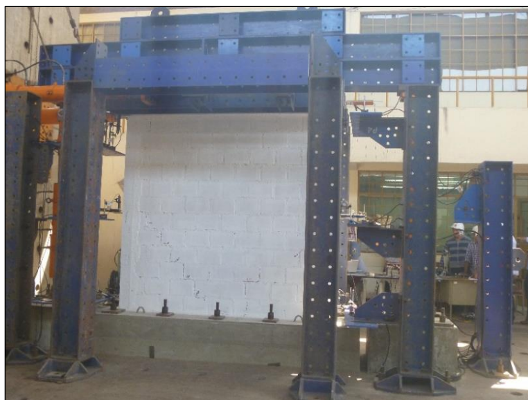
Fig. 3- 17: Muro listo para ser ensayado.
