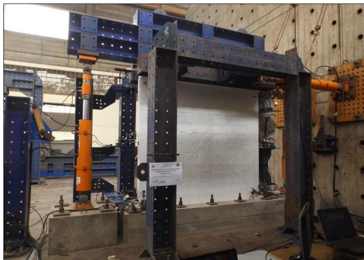
Fig. 2- 9: Mecano para el ensayo cíclico de un muro con carga coplanar, aplicada mediante deformación controlada en el laboratorio CISMID.
