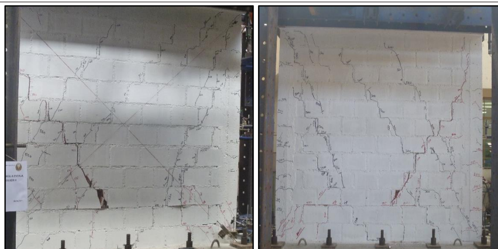
Fig. 4- 14: Vista del muro en distorsión 1/300.
