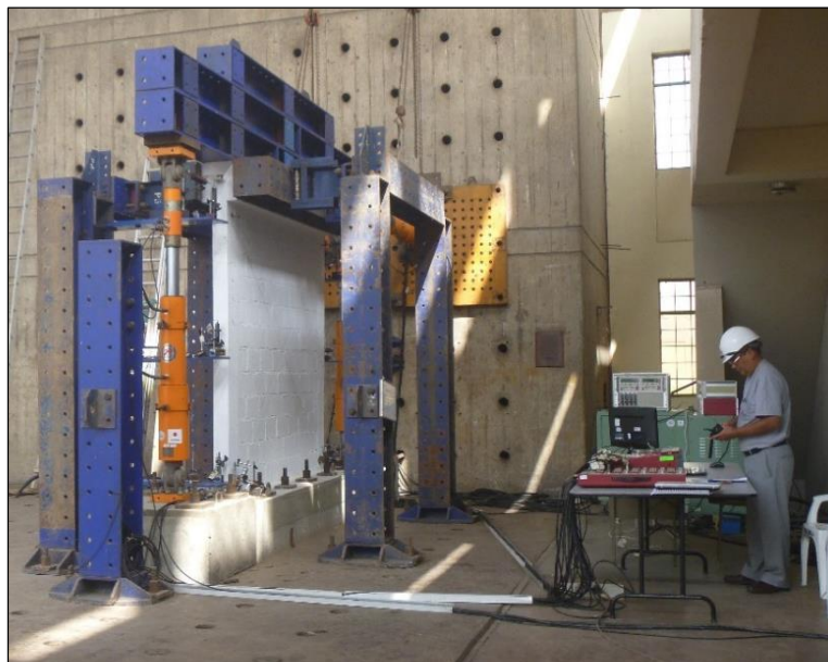
Fig. 3- 16: Montaje e Instrumentación y equipo de monitoreo del muro.
