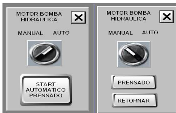
Figura 88. Pantalla de Control Manual y Automático de Motor de Bomba Hidráulica
