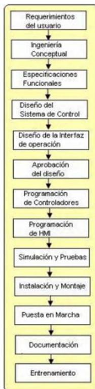
*Figura 31.* Pasos a seguir para el diseño de un sistema de automatización
