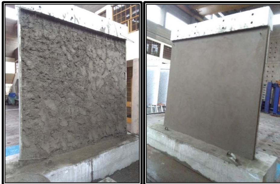
Fig. 3-16. Muro Reforzado Culminado.
