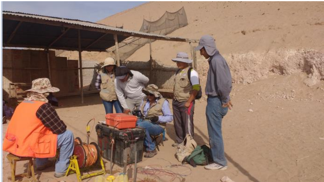
Fig. N° 01.- Brigada de Geofísica efectuando el trabajos de geofísica mediante el Método de Resistividad Eléctrica en la modalidad de Sondaje Eléctrico Vertical (SEV) en el Cerro Intiorko, sobre material seco de arenas limosas tobáceas en el Distrito de Ciudad Nueva.
