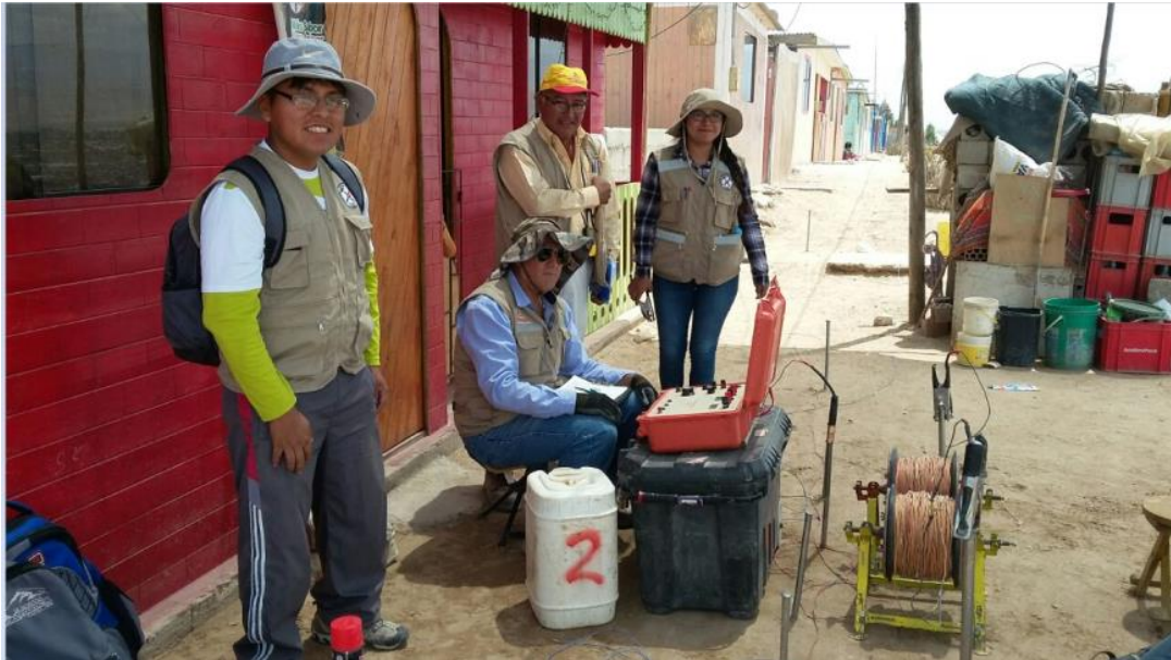
Fig. N° 03.- Sev 02, efectuado en el Talud del Cerro Intiorko sobre materiales secos limo-arcillosos. Se observa el equipo de resistividad eléctrica con cables de emisión de corriente, carretes, electrodos y personal técnico.
