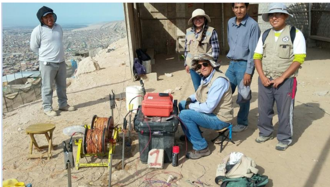
Fig. N° 02.- Personal técnico y equipo de resistividad eléctrica preparados para empezar a realizar el SEV 01 en el Cerro Intiorko sobre materiales secos limo-arcillosos.
