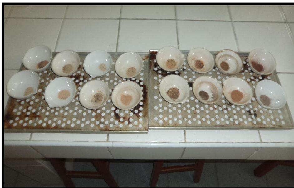
Fotografía N° 06. Proceso de molienda, las muestras pulverizadas pasaron por la malla 100 para luego ser transportadas en cápsulas hacia la estufa.
