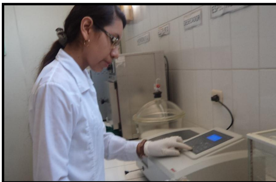
Fotografía N° 08. Proceso de colocación de muestras en el espectrofotómetro para la determinación de la fracción de carbono mediante la lectura de la Trasmitanza.
