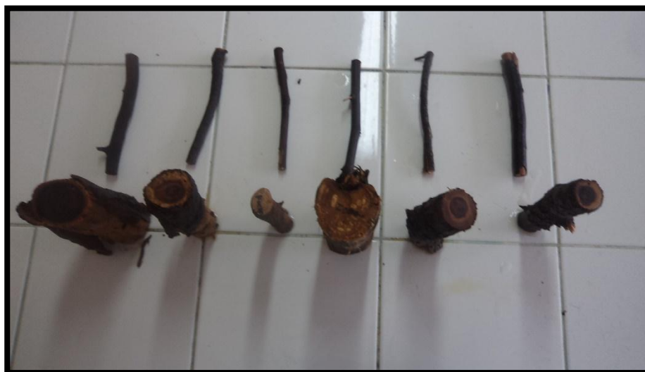
Fotografía N° 04. Se observa muestras luego de ser sumergidas aplicando el procedimiento de gravedad específica posteriormente se determinó el volumen necesario para realizar los cálculos.
