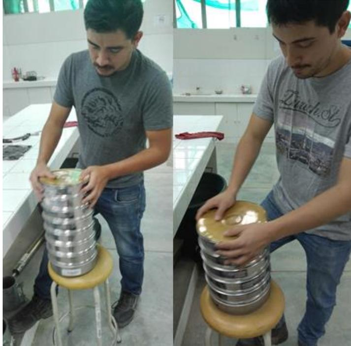
*Figura 13:* Ensayo de granulometría del agregado fino y grueso.
