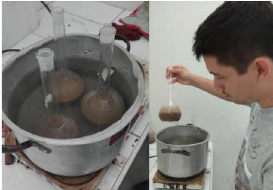
Figura 21: Baño maría del agregado fino para eliminar burbujas atrapadas. Fuente propia.
