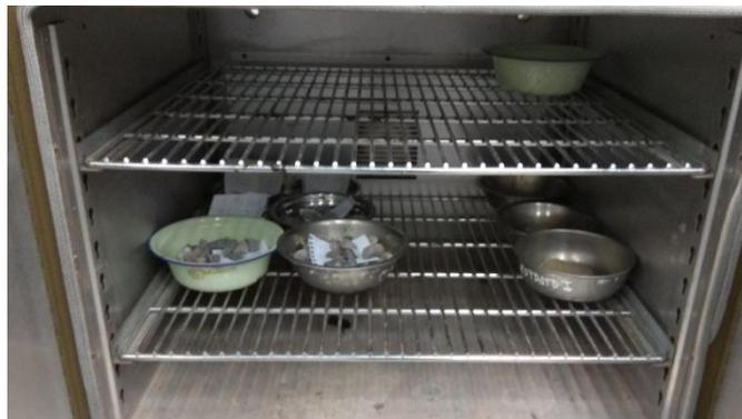
Figura 12: Agregado fino y grueso secos al cabo de 24 horas en el horno.
