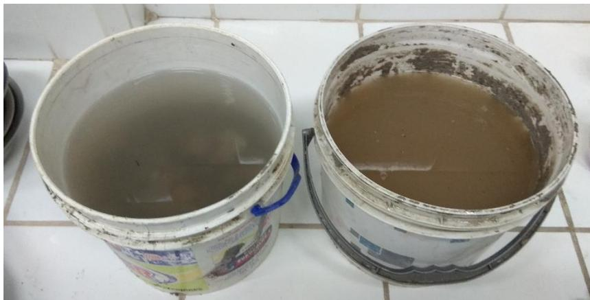
*Figura 17:* Agregados sumergidos por un periodo de 24 horas.
