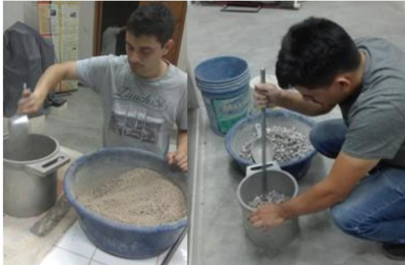
Figura 24: Ensayo de pesos unitarios de los agregados fino y grueso.
