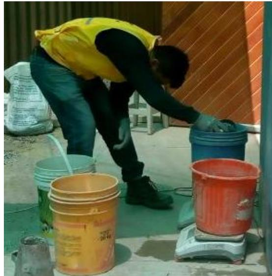
Figura 26: Pesaje de insumos para la elaboración de las probetas.
