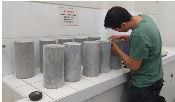
Figura 34: Toma de dimensiones de las probetas.
