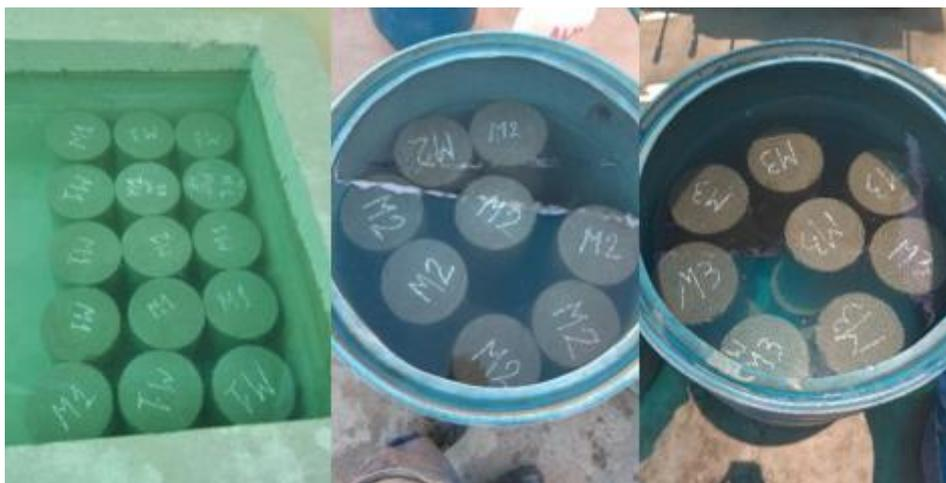
Figura 33: Curado de probetas M1 (HE + agua potable), M2 (HE + agua de pozo), M3 (HS + agua de pozo).
