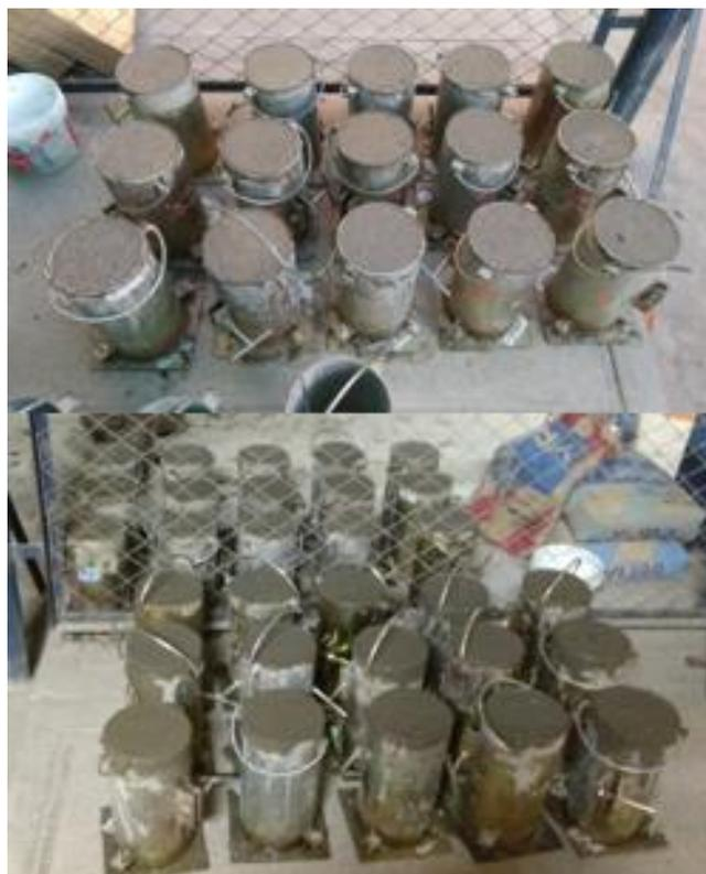
Figura 31: Vaciado de 45 probetas.
