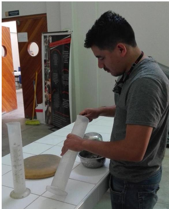
Figura 20: Colocación del agregado grueso en las probetas.
