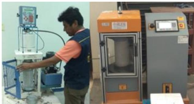
Figura 35: Ensayo de compresión de las probetas cilíndricas.
