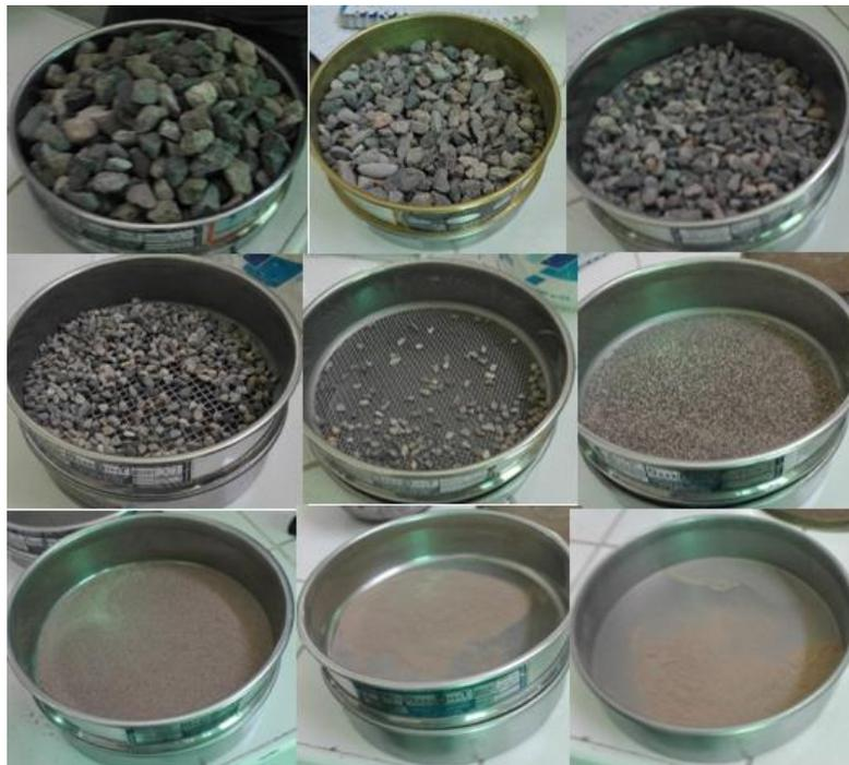
*Figura 14:* Agregados fino y grueso retenidos en los tamices.
