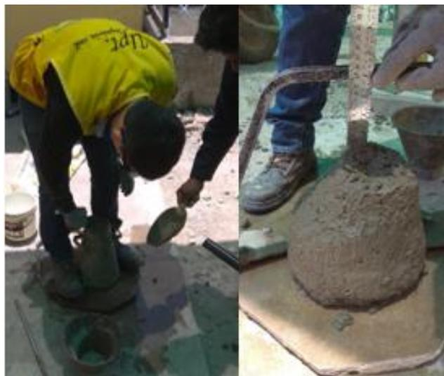
Figura 29: Ensayo de Slump con el Cono de Abrams.
