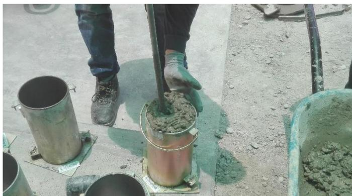
Figura 30: Método de consolidación por apisonado.
