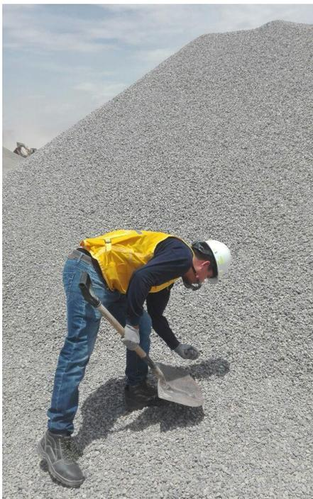
Figura 8: Extracción del agregado grueso en la Cantera Zúñiga.
