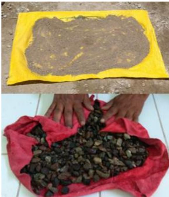
*Figura 18:* Agregado fino secado al sol y grueso secado con franela para llegar al estado saturado superficialmente seco (SSS).
