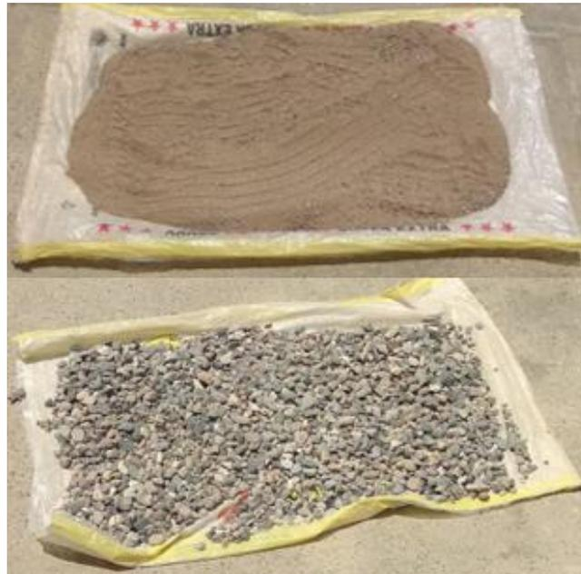
*Figura 22: Secado al sol de los agregados.*
