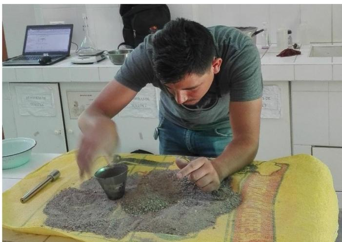
*Figura 19:* Comprobación del estado SSS del agregado fino.
