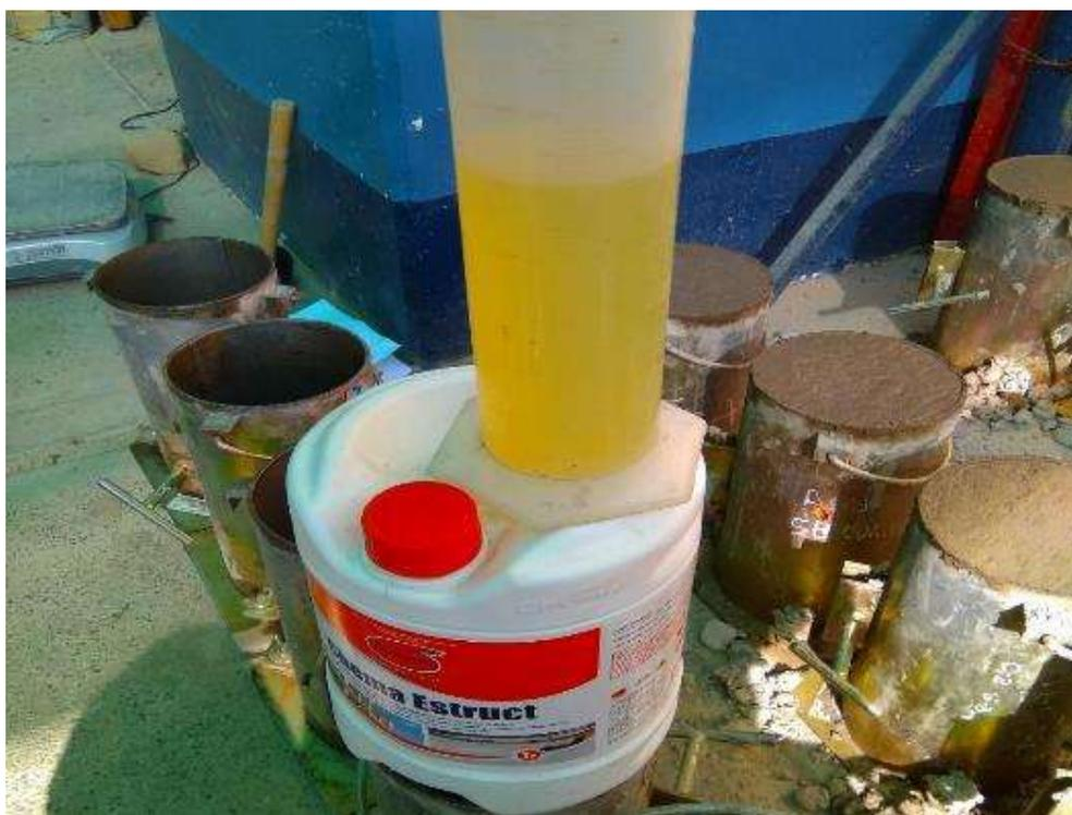
29) Adicionando el aditivo a la mezcla de concreto según cada tratamiento.
