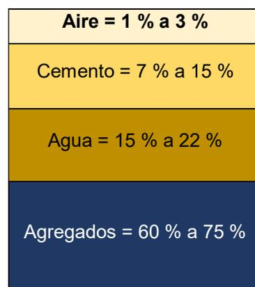
**Figura 1.** Componentes del Concreto.
