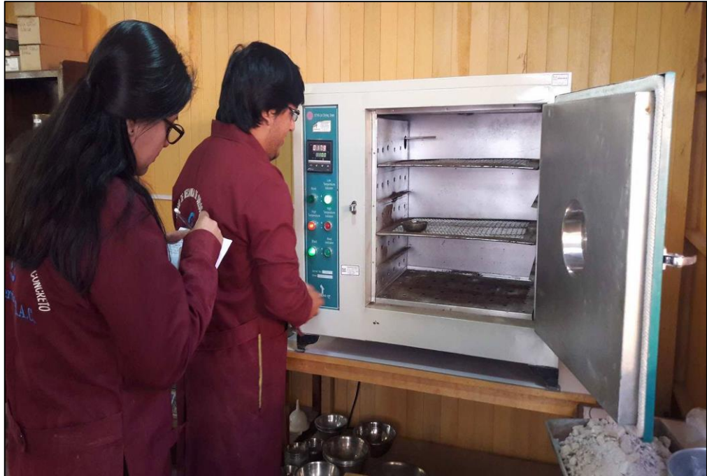
Fotografía 1. Ensayo de Contenido de Humedad; ingresando las muestras en el horno de temperatura controlada.
