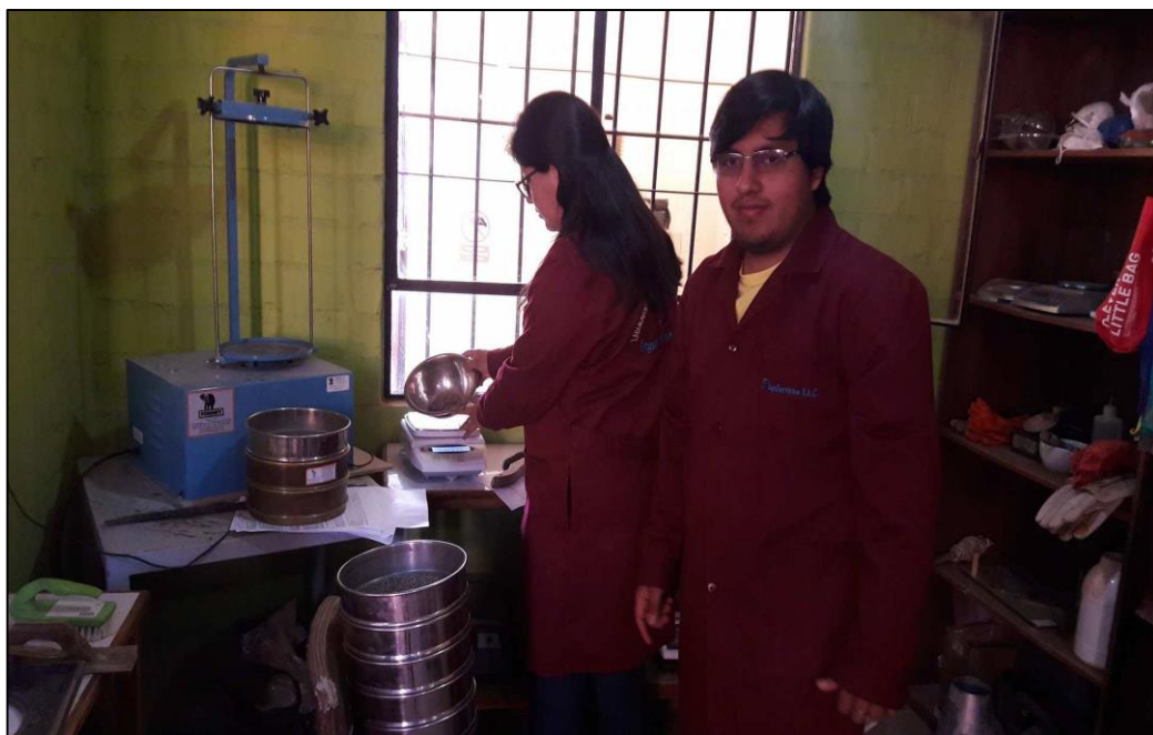
Fotografía 5. Análisis Granulométrico; controlando el peso.
