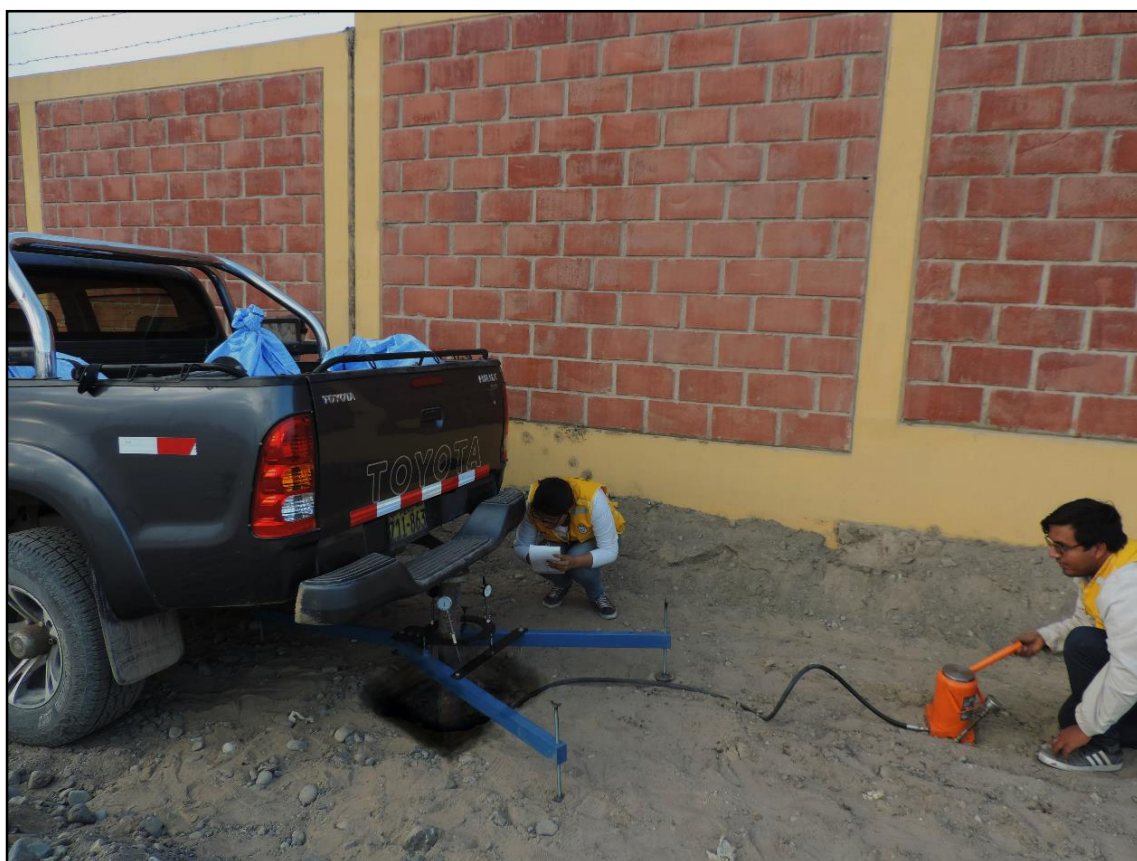
Fotografía 17. Lectura de diales para medir los asentamientos.
