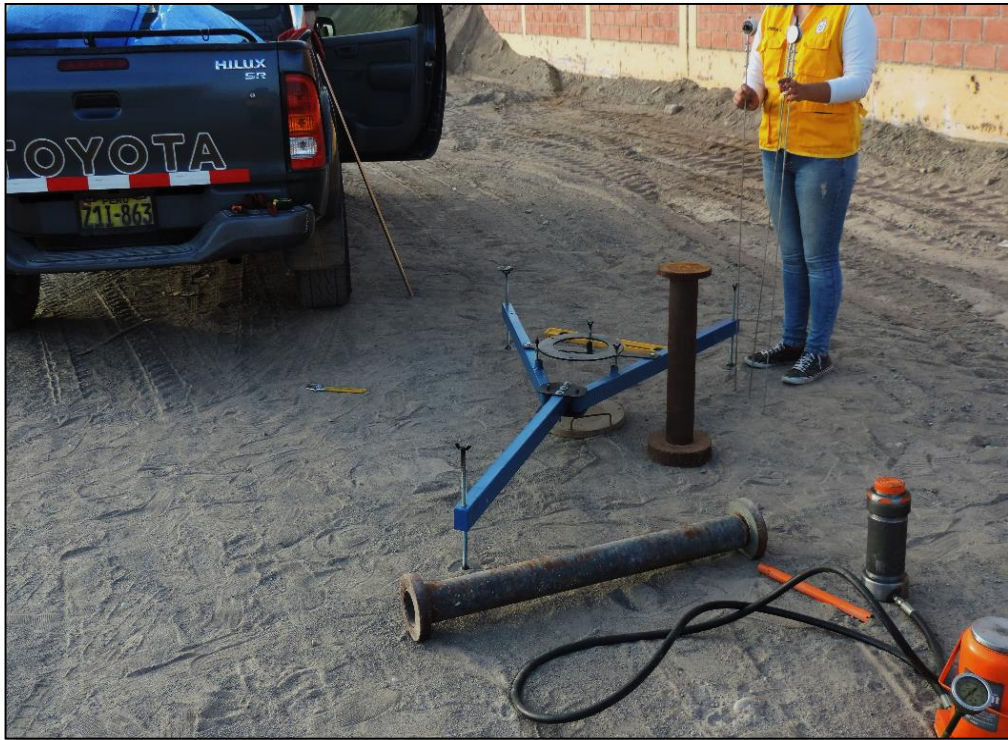
Fotografía 13. Armando el equipo de Placa de Carga Estática
