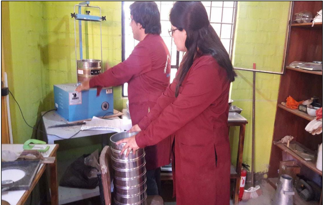
Fotografía 4. Análisis Granulométrico; realizando el tamizado de las muestras.
