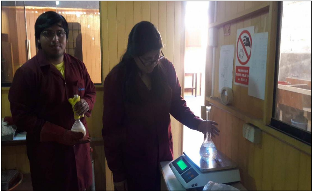
Fotografía 3. Ensayo de Peso Específico en Finos; fotografía donde se observa pesando la muestra ensayada.
