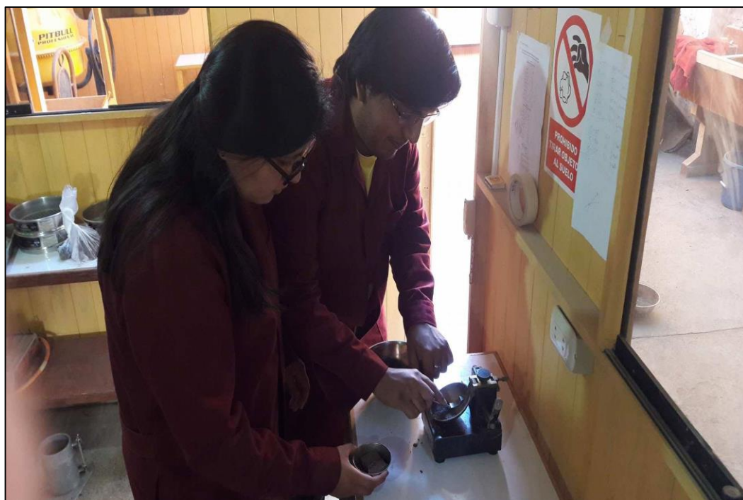
Fotografía 6. Ensayo de Límite Líquido
