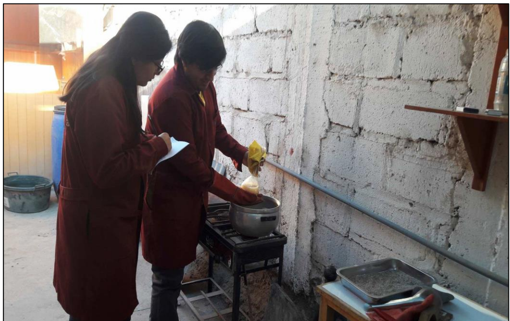
Fotografía 2. Ensayo de Peso Específico en Finos; realizando el baño María.
