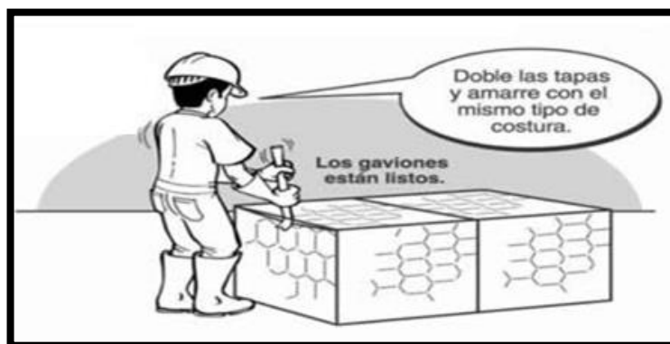
Figura N° 25: Doble las tapas y amarre con el mismo tipo de costura.
