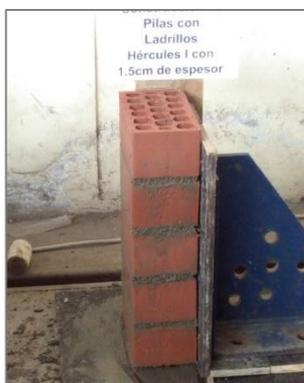
Figura 2.1. Pilas con Ladrillos Hércules I con 1.5 cm de espesor
