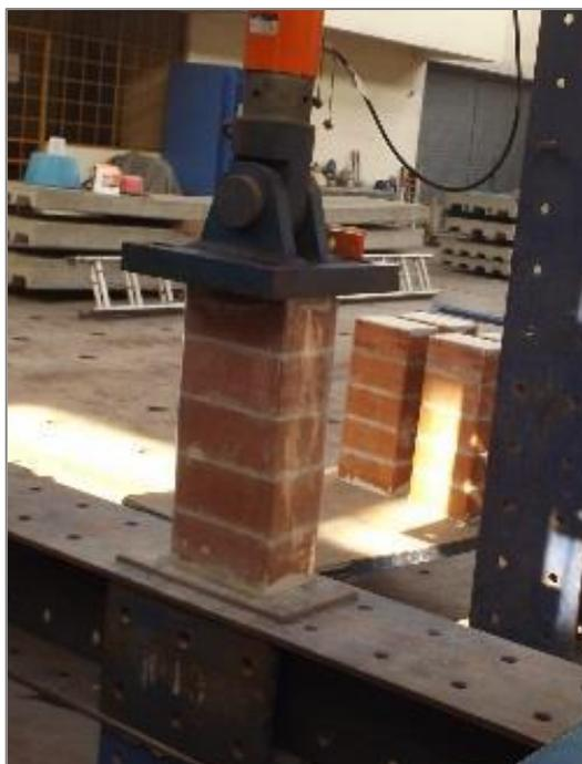
*Figura 4.1. Ensayo de Compresión Axial*
