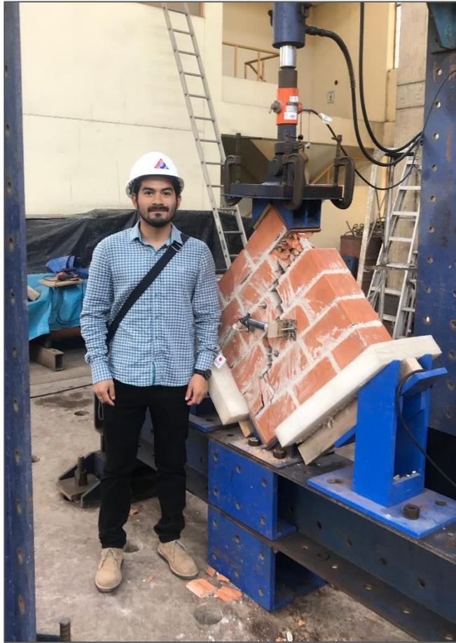
Fotografía N°06. Ensayo final del murete de ladrillos de arcilla Hércules I con un espesor de mortero igual a 1.5 cm.
