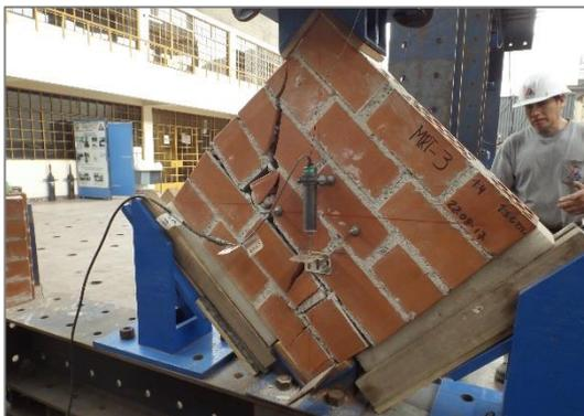
*Figura 4.2. Falla escalonada en muretes.*
