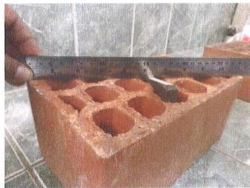
Figura 2 Ensayo de alabeo
