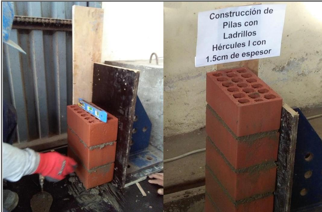
Fotografía N°02. Construcción de Pilas de ladrillos de arcilla Hércules I con un espesor de mortero igual a 1.5 cm, de izquierda a derecha:
