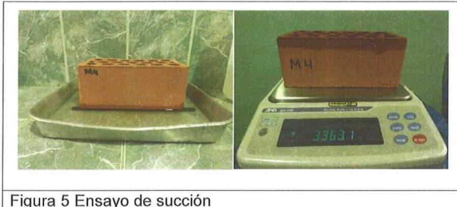
Figura 5 Ensayo de succión
