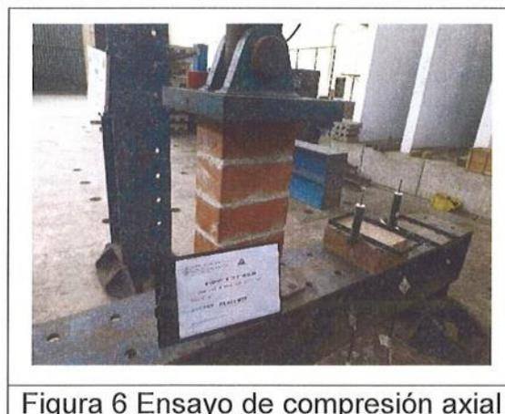
Figura 6 Ensayo de compresión axial
