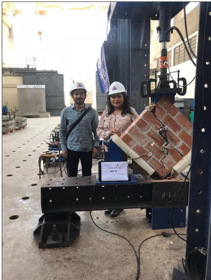
*Figura 3.1. Ensayo de Murete de ladrillo de arcilla Hércules I*
