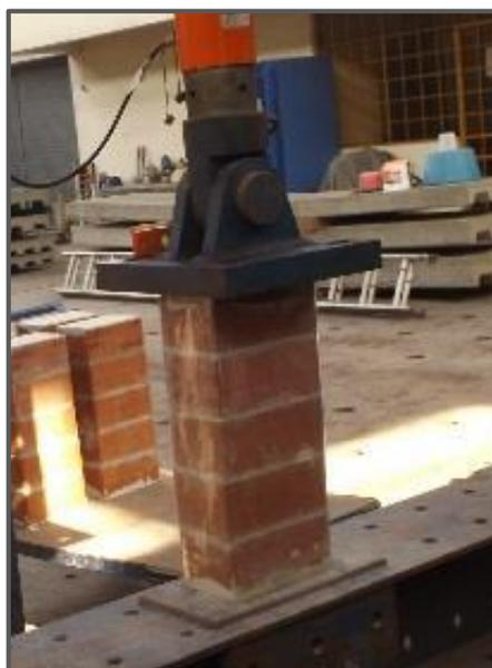
Fotografía N°03. Ensayo de Compresión Axial
