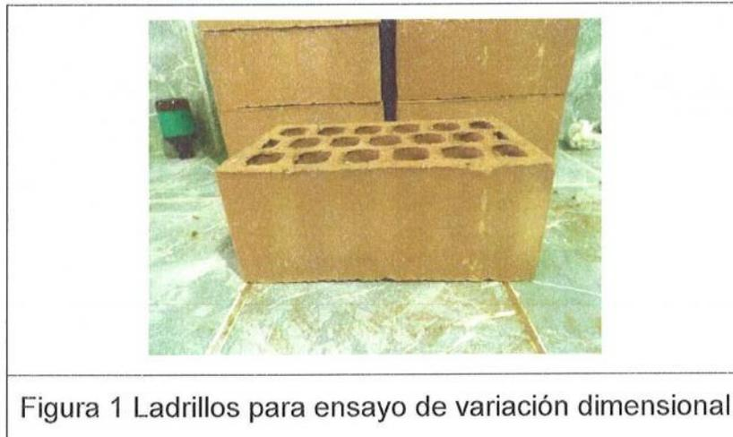
Figura 1 Ladrillos para ensayo de variación dimensional
