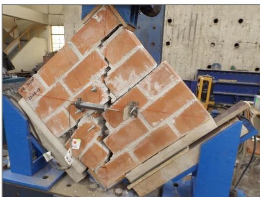
*Figura 4.3. Falla por Deslizamiento en murete.*
