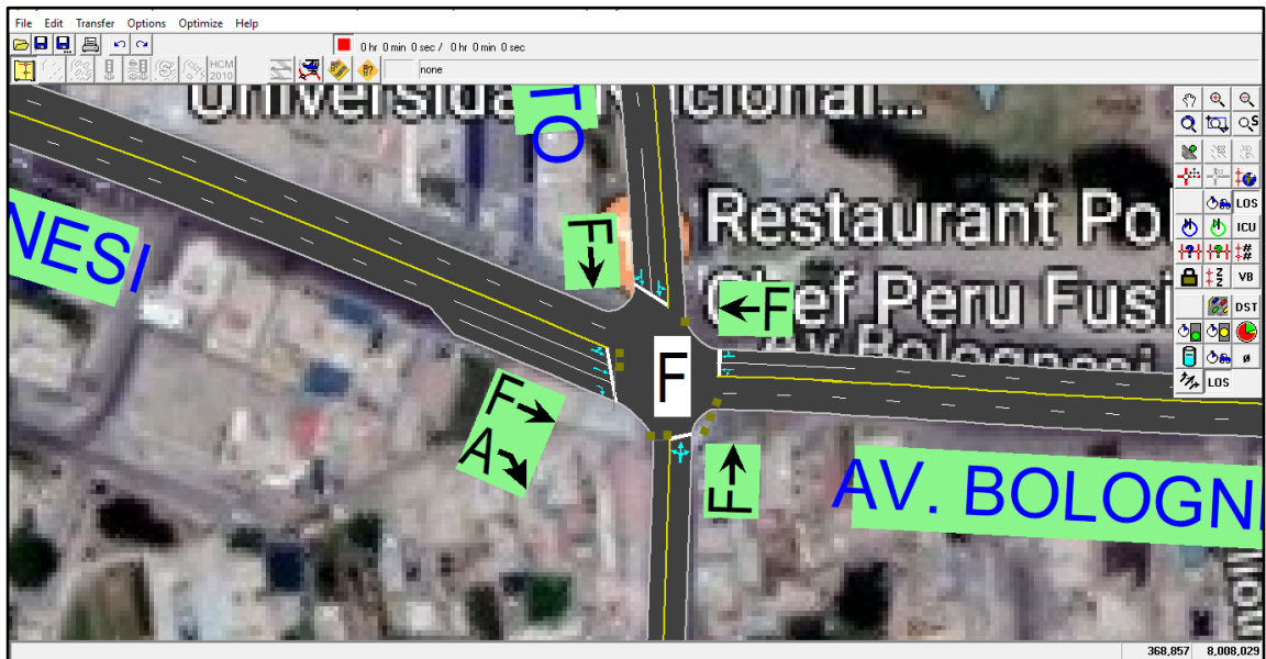
Figura 157: Niveles de servicio por acceso y nivel de servicio de la intersección con Optimización de tiempos de semáforos.
