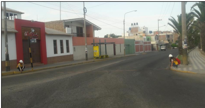
Foto 11: Se hicieron mediciones en campo para hallar las características geométricas del acceso SO (ancho de la calzada, ancho de carriles, etc.)
