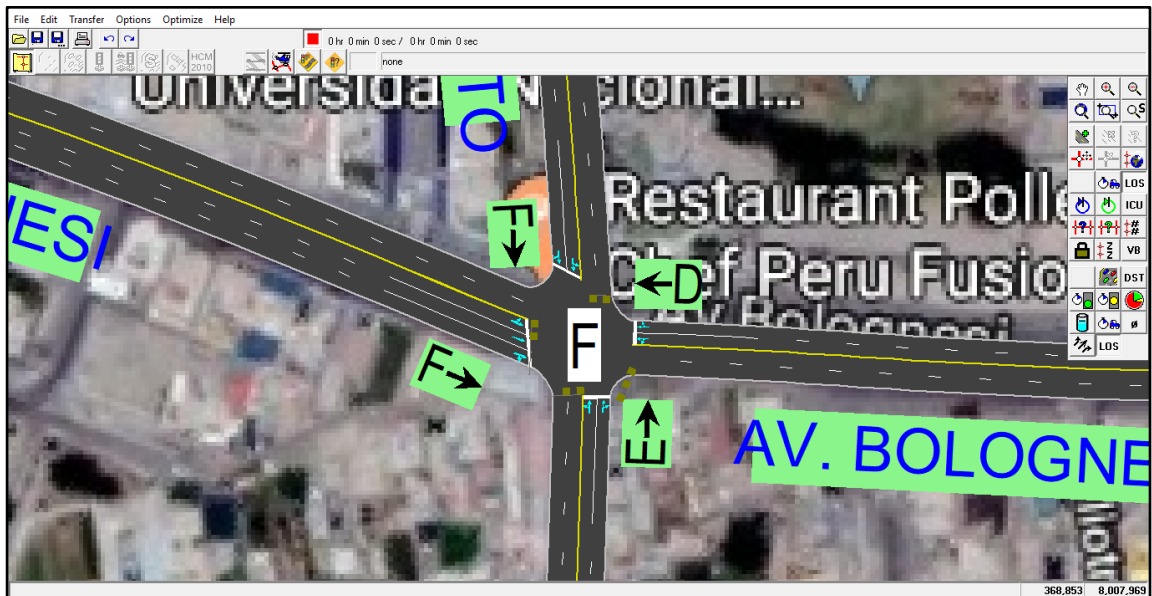
Figura 166: Niveles de servicio por acceso y nivel de servicio de la intersección con el aumento de carriles opción 1.
