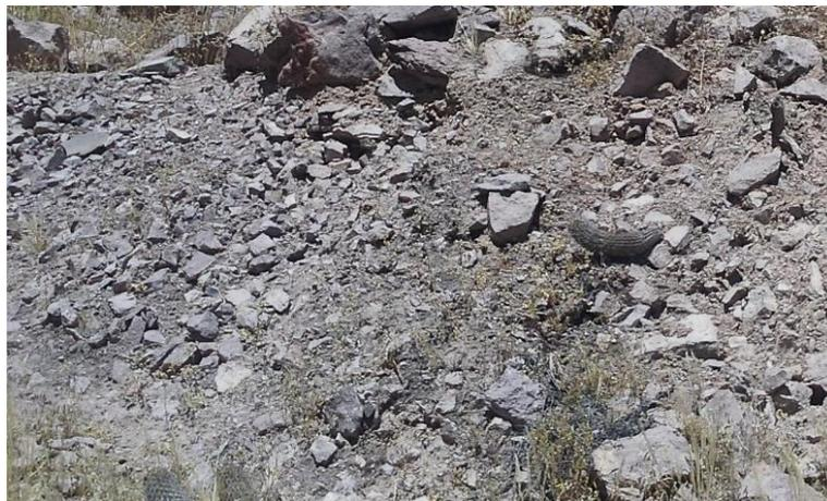
***Figura 86:*** Cascajo meteorizado de los afloramientos rocosos presentes de dacitas y andesitas mezcladas con suelo limoso.
