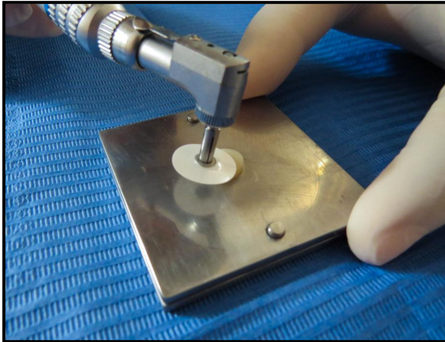
Fig. 22 Pulido de muestra de resina con disco soflex de grano extra fino
