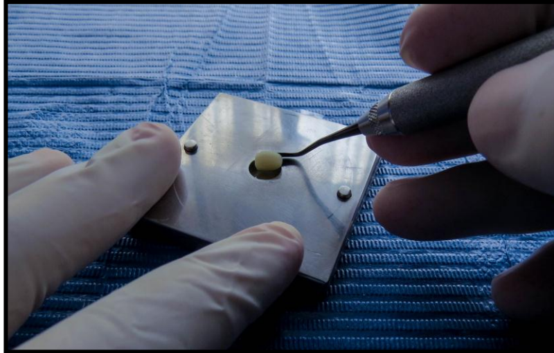
Fig. 08 Aplicación de resina por el método de incrementos
