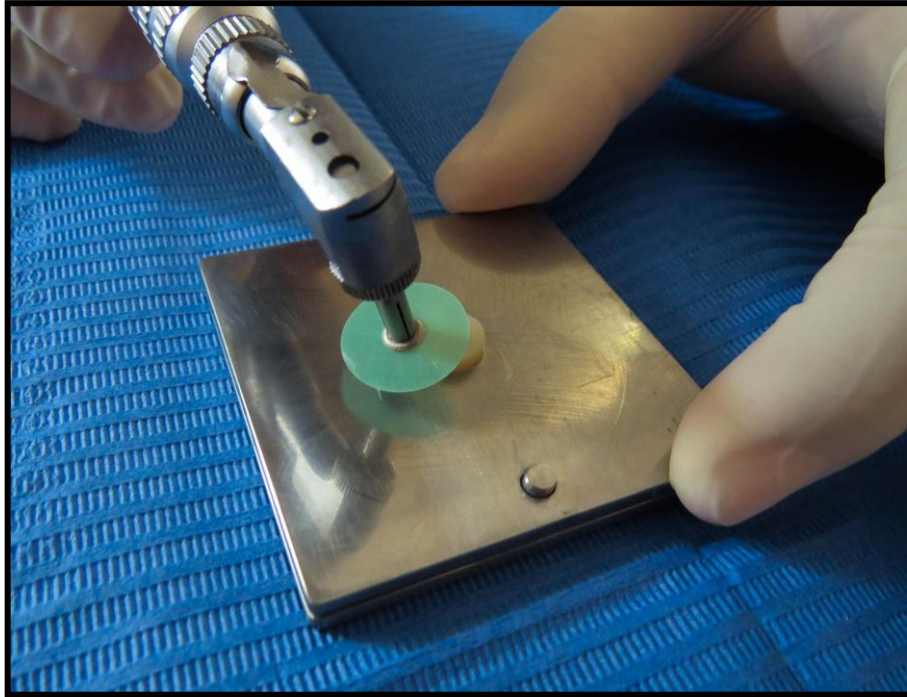
Fig. 20 Pulido de muestra de resina con disco soflex de grano medio
