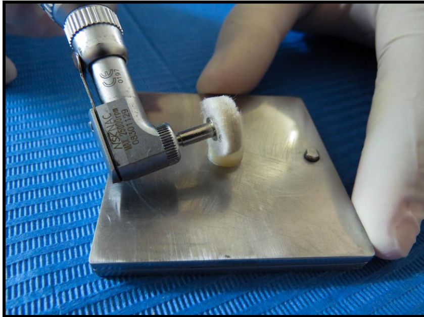
Fig. 24 Pulido final con fieltro y pasta diamantada
