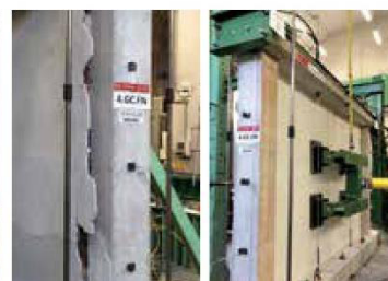
PROVE COMBinate NEL PIANO E FUORI DAL PIANO DI TAMPONATURE RINFORZATE
