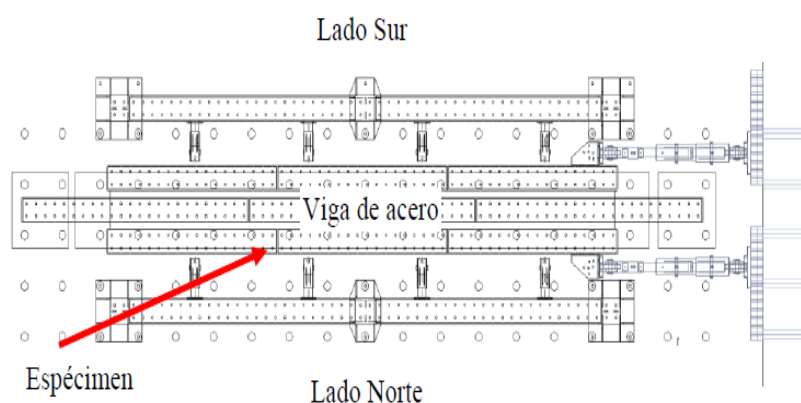
Figura 4.20 Vista en planta del aparato de carga
