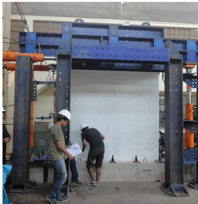
Foto 4.3 Vista de daños para el ED1 de un muro de ductilidad limitada
