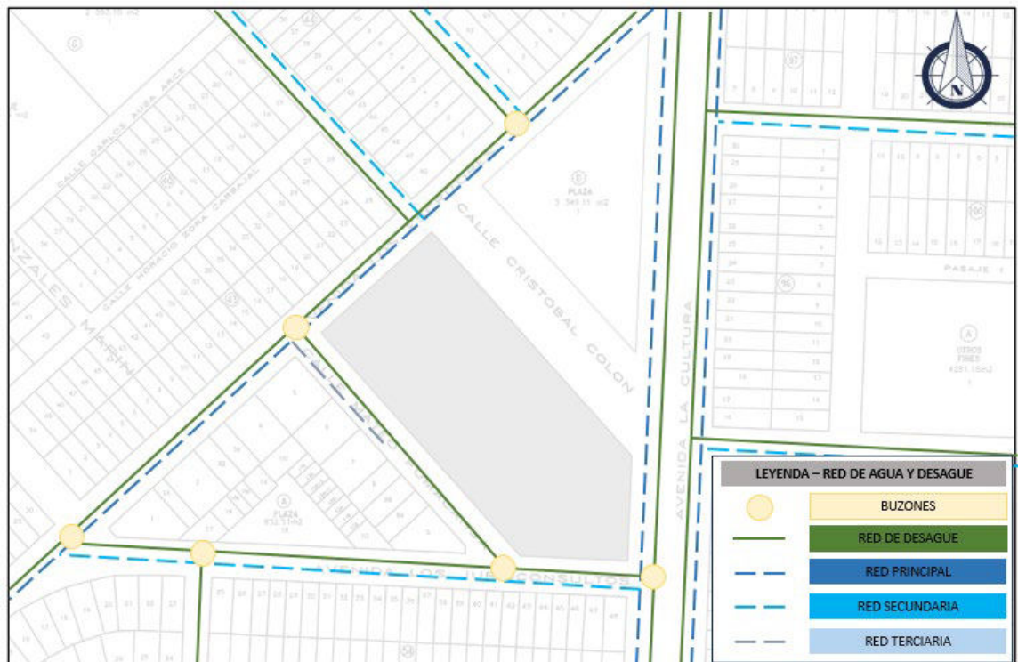
Red de Agua y Desagüe existente
