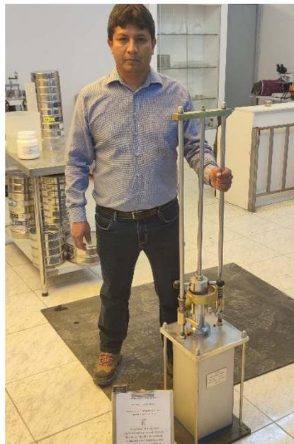
*Nota.* Equipo empleado en la elaboración de mezclas asfálticas para pavimentos, particularmente en pruebas de estabilidad y deformación de mezclas bituminosas.
