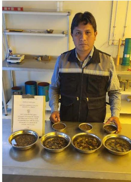
*Nota.* Ejecución del ensayo de pérdidas en sulfato de sodio según la Norma MTC E 124
