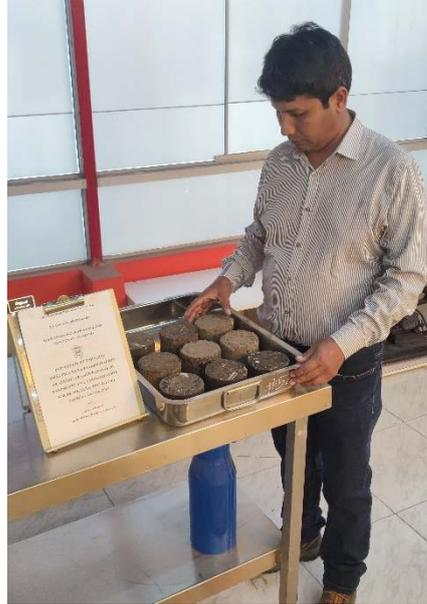
*Nota.* Vertido de la mezcla de suelo y emulsión en moldes cilíndricos con dimensiones determinadas.
