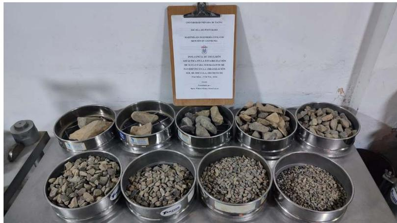
*Nota.* Se muestra la retención del agregado grueso según el tamiz.
