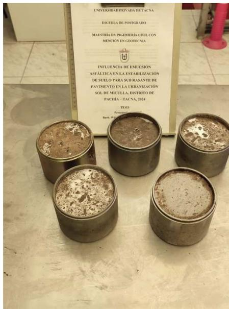
*Nota.* Procedimiento utilizado en la preparación de muestras para ensayos de estabilidad y flujo en mezclas asfálticas.
