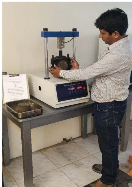
*Nota.* Equipo empleado en ensayos de estabilidad y flujo en mezclas asfálticas utilizando el método Marshall.
