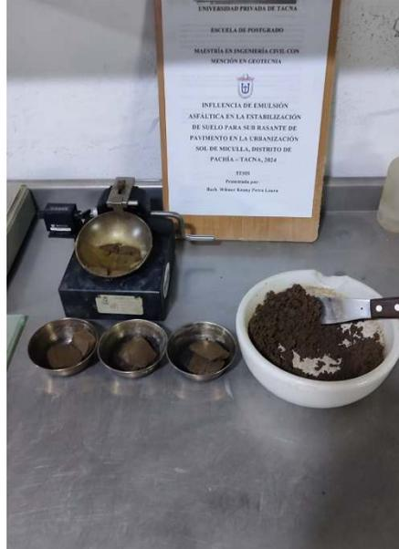
*Nota.* Ejecución de límite líquido para suelos según la Norma MTC E 103
