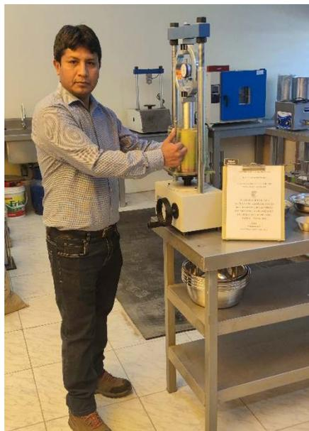
*Nota.* Ejecución del Ensayo de Índice de Capacidad de Carga (CBR) según la Norma MTC E 170
