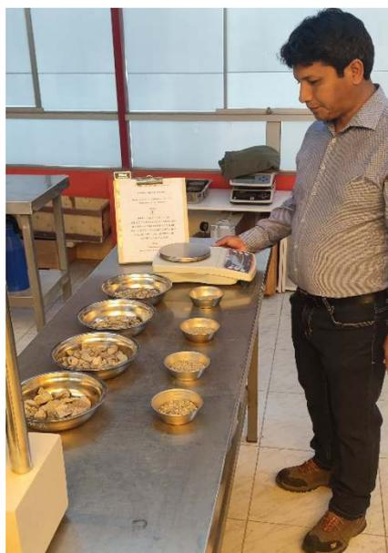
*Nota.* Ejecución del ensayo de pérdidas en sulfato de magnesio está regulado por la Norma MTC E 124
