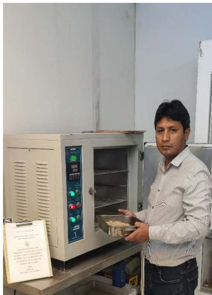
*Nota.* Ejecución de la Determinación del contenido de humedad de un suelo según la Norma MTC E 108
