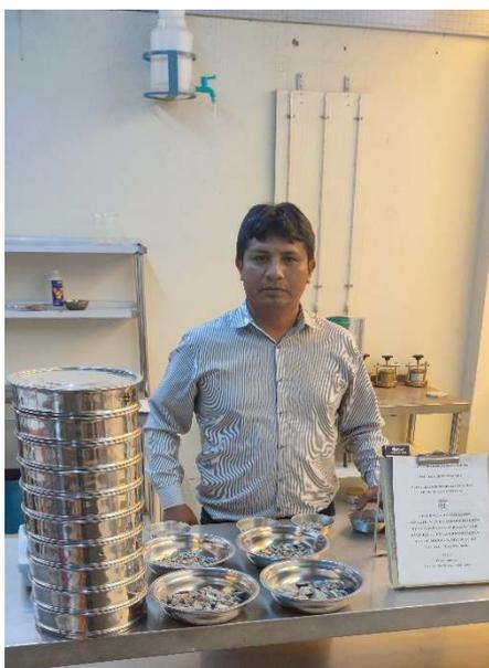
*Nota.* Ejecución del Análisis Granulométrico de Suelo según la Norma MTC E 107
