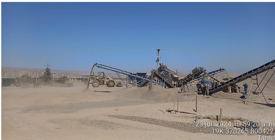
La fotografía 5 muestra el acopio del material procesado para su comercialización mediante el uso de maquinaria pesada (cargador frontal).
