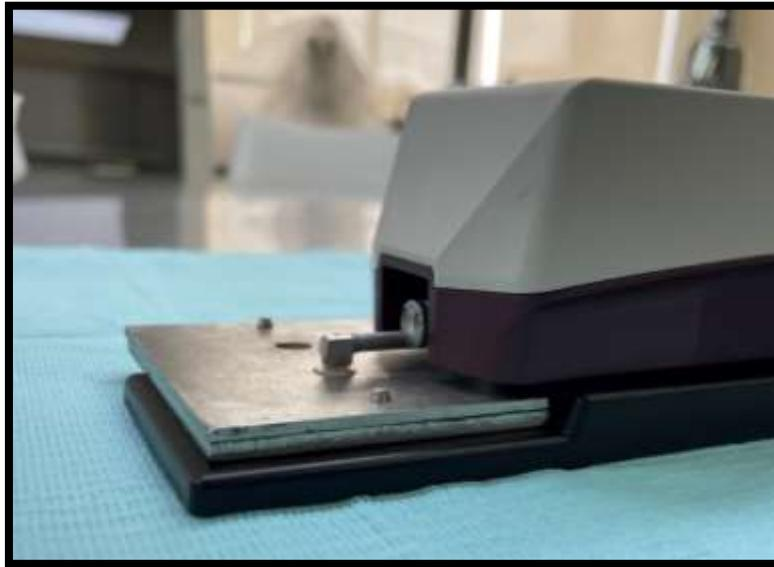
**Figura 6.-** Rugosímetro en funcionamiento con la muestra en el soporte de acero.
