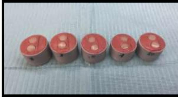
**Figura 4.-** Muestras en soporte de polivinilo (PVC) y silicona de condensación.
