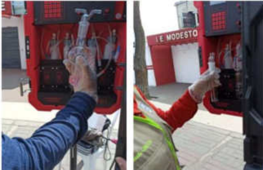
Fotografía 4. Instalación del equipo y de los impingers a inmediaciones de la IE Modesto Basadre – Av. Hipólito Unzué
