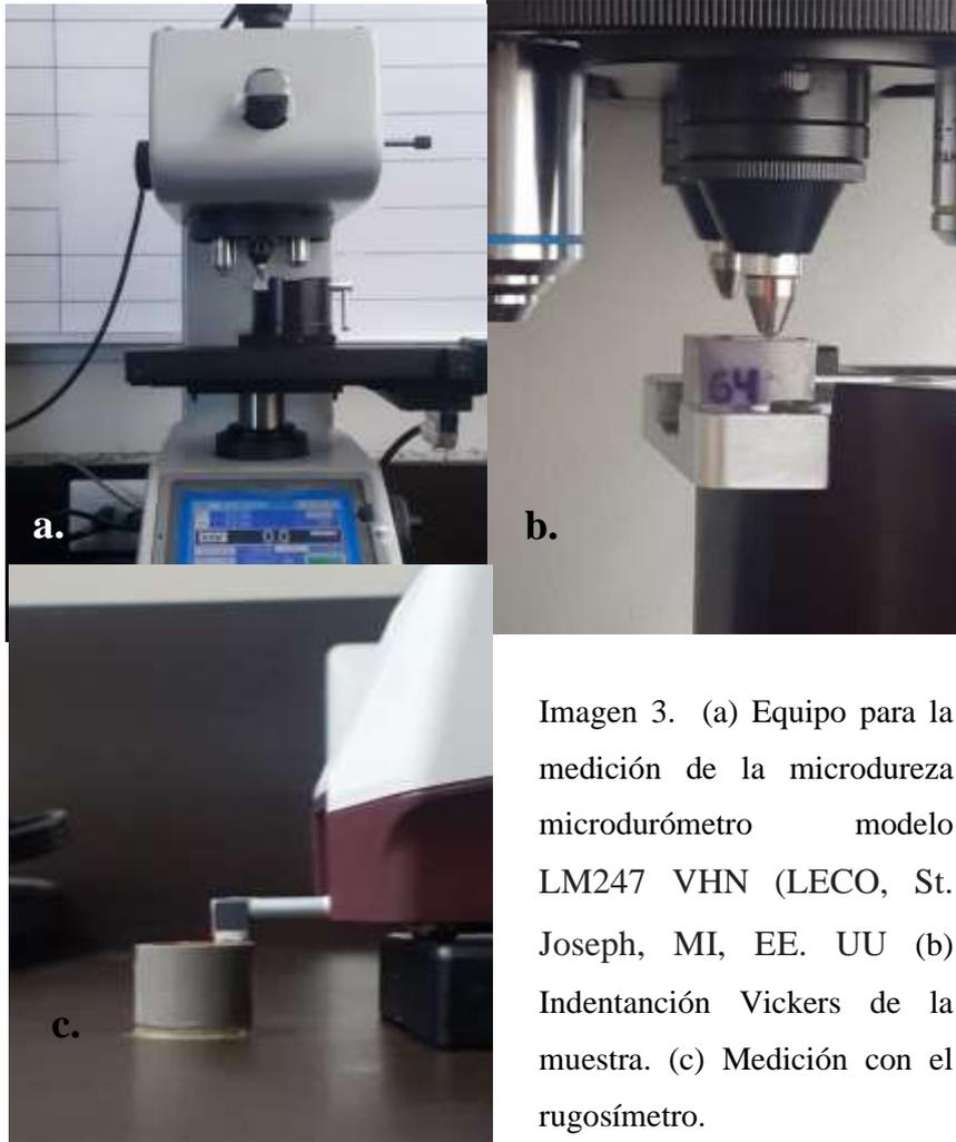
Imagen 3. (a) Equipo para la medición de la microdureza microdurómetro modelo LM247 VHN (LECO, St. Joseph, MI, EE. UU) (b) Indentación Vickers de la muestra. (c) Medición con el rugosímetro.
