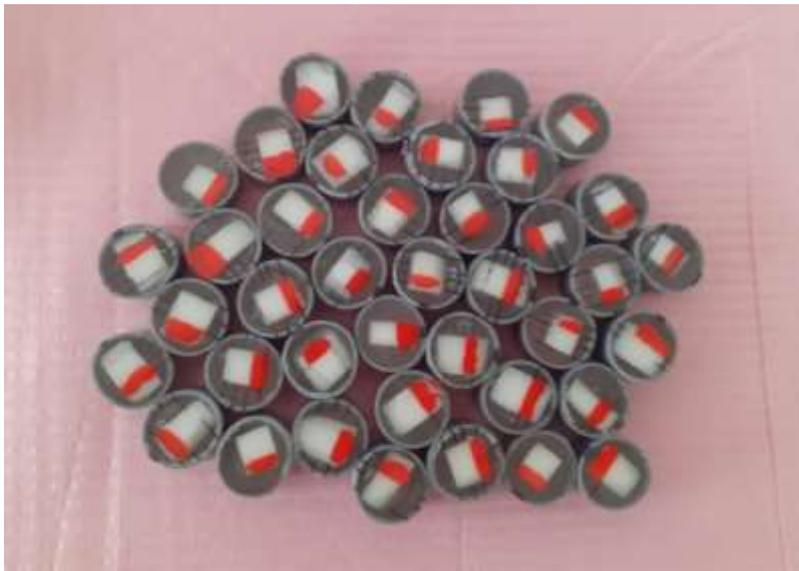
Imagen2. Total de muestras, cubiertas en 1/3 con esmalte de resistente a ácidos
