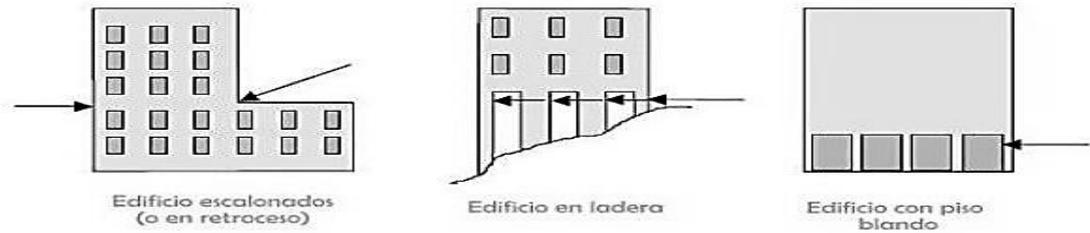
Nota. Irregularidades verticales en las edificaciones. Rapid Visual Screening of Buildings for Potential Seismic Hazards (FEMA 154).
