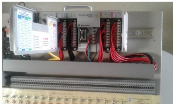
**Figura 23: Inserción del CompactLogix en el rack
