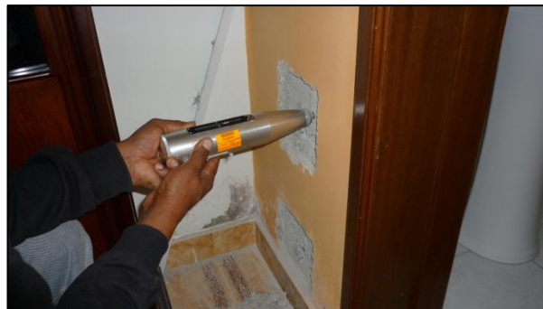
Figura 67. Ensayo de esclerometría de zona sana.
