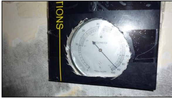
Figura 64. Medición con higrómetro de pelo
