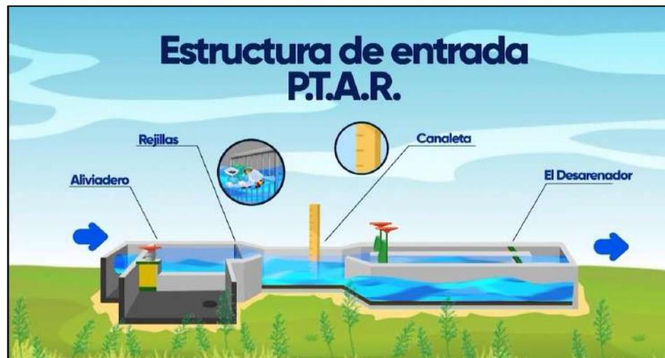
**Figura 19:** Esquema de Planta de Tratamiento de Agua Residual
