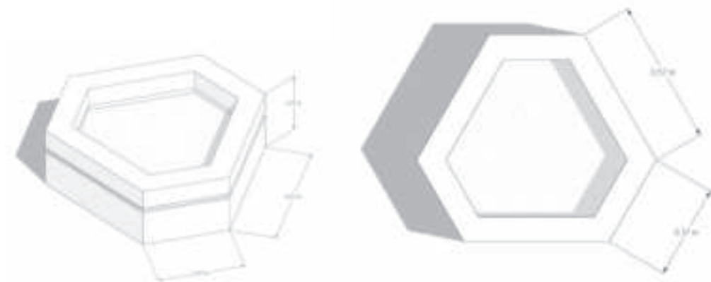
Detalle de Alcorque exterior de concreto
