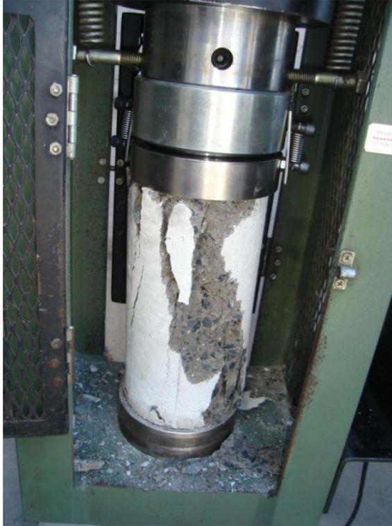
*Nota.* Podemos apreciar un testigo de concreto que ha sido sometido a un ensayo de resistencia a la compresión que ha sufrido su rotura debido a la fuerza que ha sido sometida. *Fuente.* Foto extraída de (Cansuas ingeniería, 2023).
