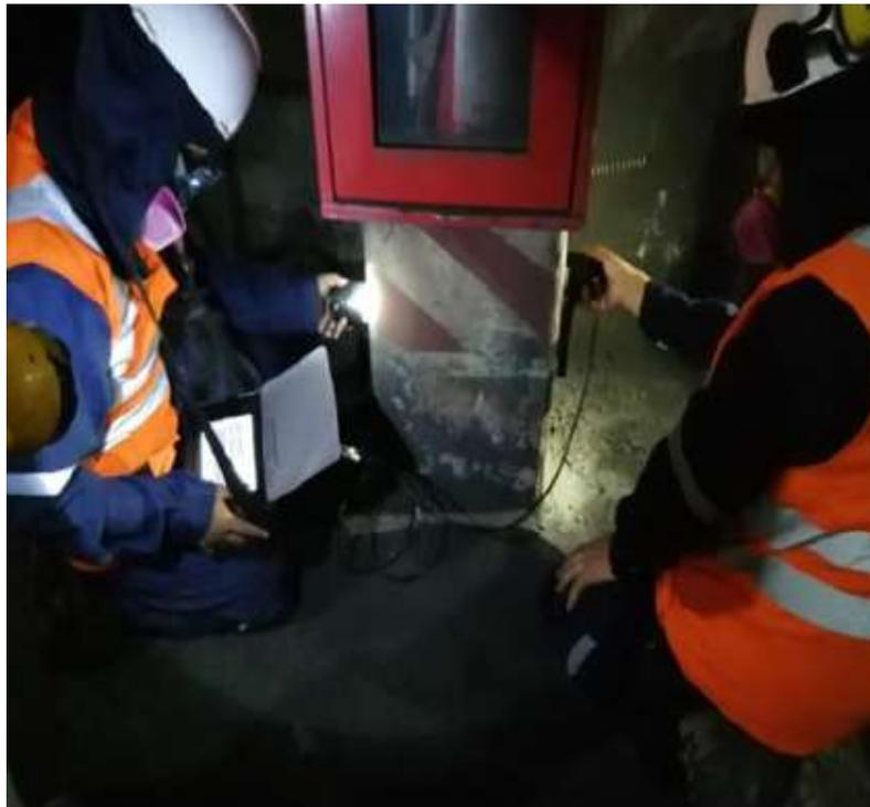
*Nota.* Se configuro el ensayo UPV de manera directa *Fuente.* Foto, tomada el día de la realización del ensayo in situ.
