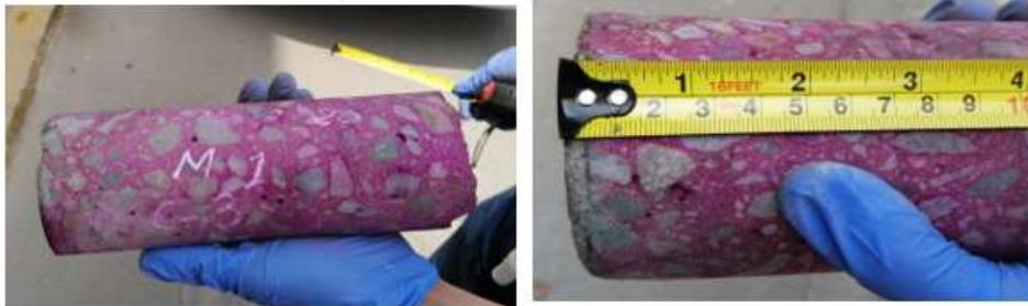
*Nota.* Se encontró una profundidad de carbonatación 4 mm *Fuente.* Foto tomada el día del ensayo de carbonatación realizado en situ.
