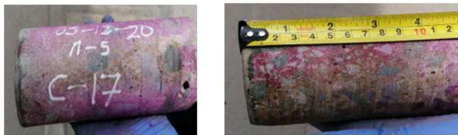
*Nota.* Se encontró una profundidad de carbonatación 6 mm. *Fuente.* Foto tomada el día del ensayo de carbonatación realizado en situ.
