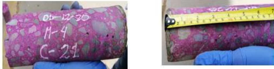
*Nota.* Se encontró una profundidad de carbonatación 10 mm *Fuente.* Foto tomada el día del ensayo de carbonatación realizado en situ.
