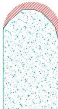
*Nota.* Esta tiene una sección a 1,00m de altura con una disminución de su sección en un 9,72 %. *Fuente.* Imagen extraída del software Autocad
