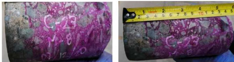
*Nota.* Se encontró una profundidad de carbonatación 25 mm *Fuente.* Foto tomada el día del ensayo de carbonatación realizado en situ.
