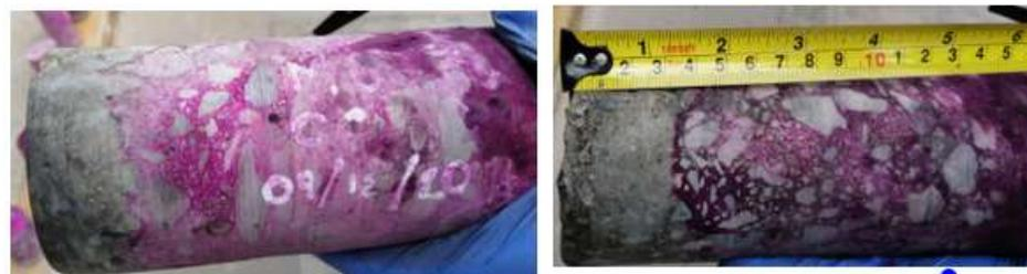
*Nota.* Se encontró una profundidad de carbonatación 32 mm *Fuente.* Foto tomada el día del ensayo de carbonatación realizado en situ.
