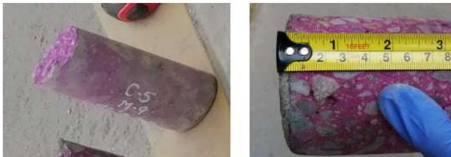
*Nota.* Se encontró una profundidad de carbonatación 5 mm *Fuente.* Foto tomada el día del ensayo de carbonatación realizado en situ.
