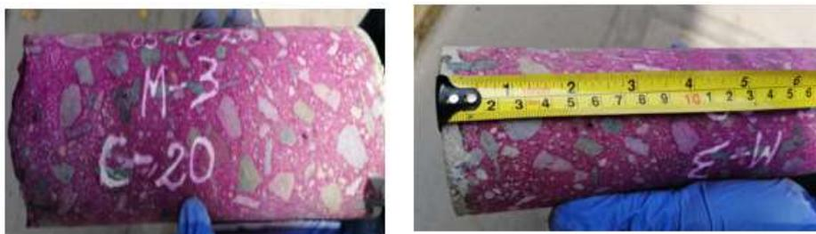
*Nota.* Se encontró una profundidad de carbonatación 7 mm *Fuente.* Foto tomada el día del ensayo de carbonatación realizado en situ.
