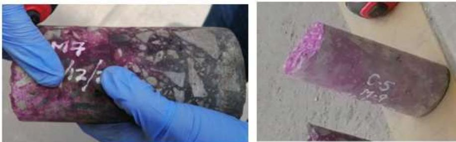
*Nota.* Se encontró una profundidad de carbonatación 45 mm *Fuente.* Foto tomada el día del ensayo de carbonatación realizado en situ.
