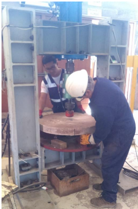
Laboratorio de Estructuras Antisísmicas de PUCP para ensayo de resistencia a la flexión (ASTM-C1550)
