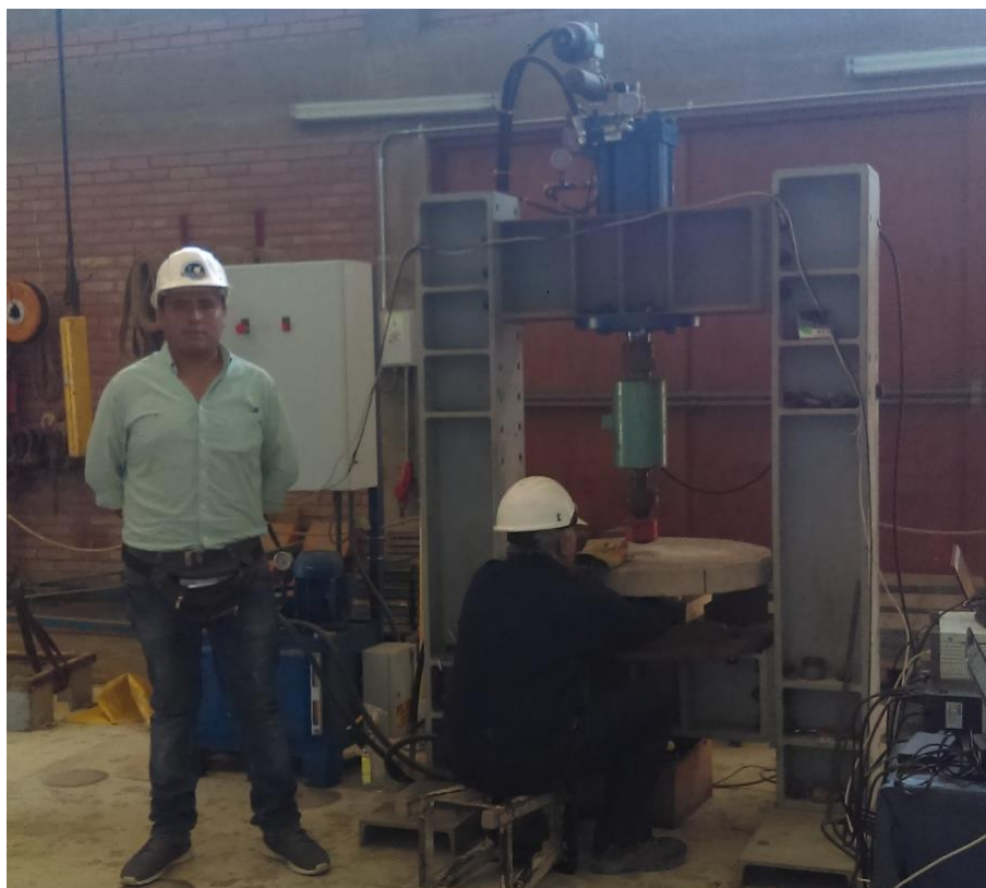
Laboratorio de Estructuras Antisísmicas de PUCP para ensayo de resistencia a la flexión (ASTM-C1550)
