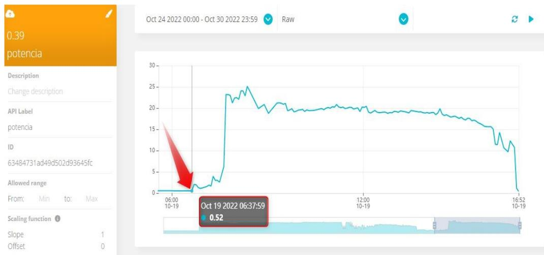
En la figura 113, se observa la caída de la potencia en la tarde (16:52), lo cual concuerda con el desplazamiento solar, debido a que en el atardecer el sol se va y por tanto la potencia que recibe el panel disminuye.
