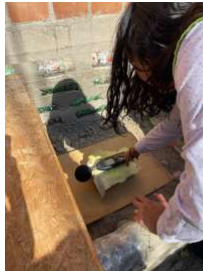
Medición de Aislamiento acústico en el Prototipo A - ecoladrillos
