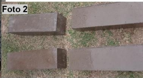
Foto 1,2,3: Secado previo ensayo, siguiendo consignas de norma. Foto 4,5,6: Medición de largo y ancho.
