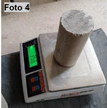
Foto 4: Pesaje de probeta
