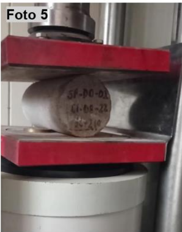
Foto 6: Ensayo a compresión diametral
