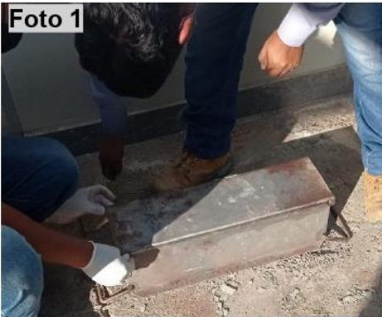
Foto 1: Armado de molde Foto 2,3: Aplicación de petróleo al molde.
