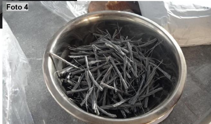
Foto 3,4: Pesaje de la fibra que se añadirá a la mezcla, para esta investigación se usó macro fibra de polipropileno monofilamento fibrilada POLYTWIST PT54
