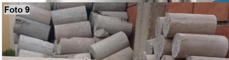
Foto 7: Resultado de ensayo a compresión diametral
