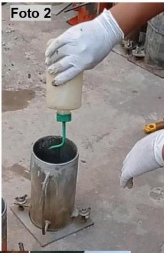
Foto 1: Armado de moldes Foto 2: Aplicación de petróleo a los moldes.
