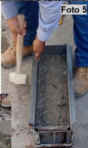
Foto 4,5: Varillado y golpeteo con martillo, en dos capas según norma.
