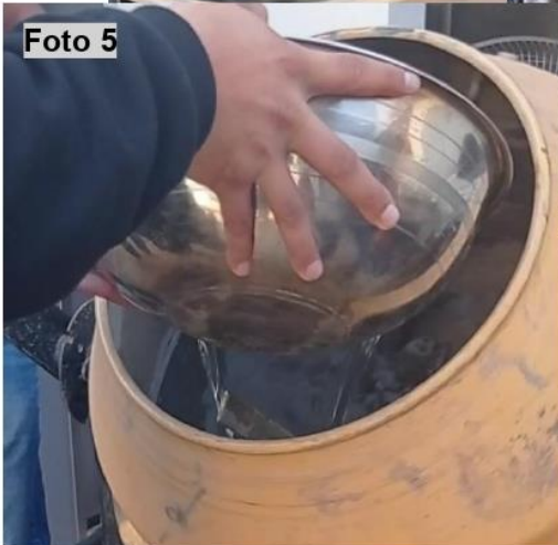
Foto 6,7: Mezcla de concreto con adición de fibra, consistencia deseada.
