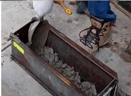
Foto 4,5: Varillado y golpeteo con martillo, en dos capas según norma.
