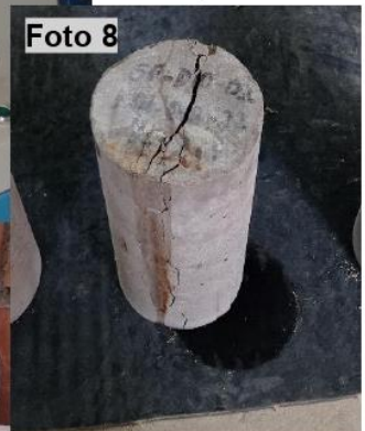
Foto 8,9: Falla y acopio de testigos ensayados
