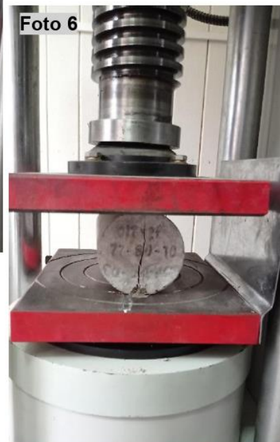
Foto 5: Colocación en prensa de ensayo
