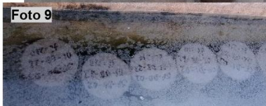
Foto 8,9: Codificación y curado completamente sumergido.
