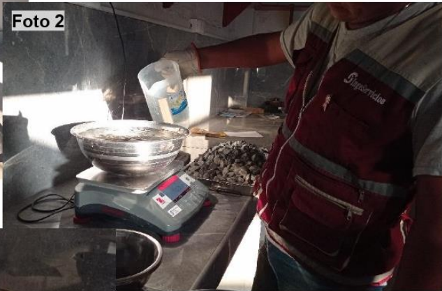
Foto 2: Pesaje de los materiales componentes de la mezcla de concreto, medidas tomadas del diseño de mezcla
