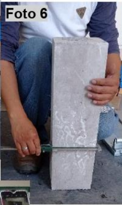
Foto 1,2,3: Secado previo ensayo, siguiendo consignas de norma. Foto 4,5,6: Medición de largo y ancho.
