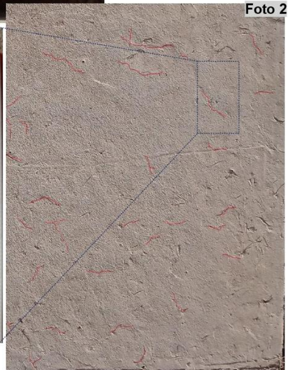
Foto 2: Identificación de la microfisuras que aparecieron en los 28 días.
