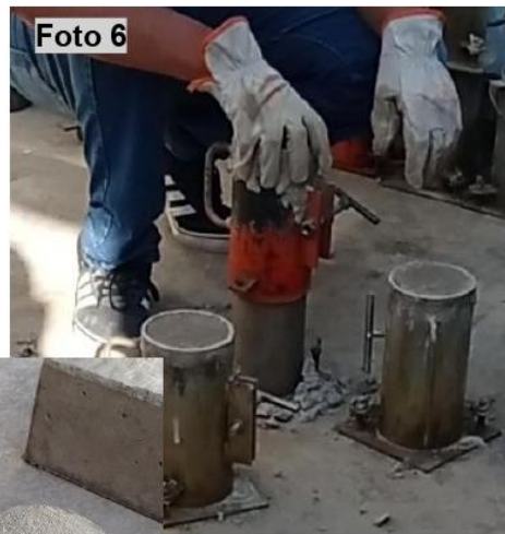
Foto 6,7: Desmoldaje de probetas de concreto.
