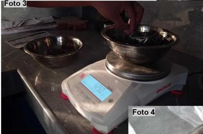
Foto 3,4: Pesaje de la fibra que se añadirá a la mezcla, para esta investigación se usó macro fibra de polipropileno monofilamento fibrilada POLYTWIST PT54
