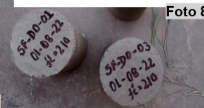
Foto 8,9: Codificación y curado completamente sumergido.
