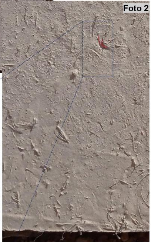
Foto 2: Identificación de la microfisuras que aparecieron en los 28 días
