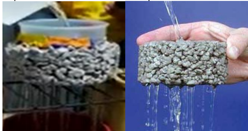
Figura 8 Capacidad de filtración del concreto permeable
