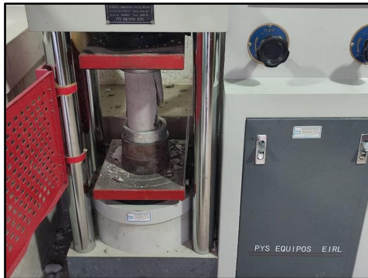
Fotografía 10. Se ensaya las muestras cilíndricas a los 14, 21 y 28 días para obtener la resistencia que alcanza las muestras de concreto
