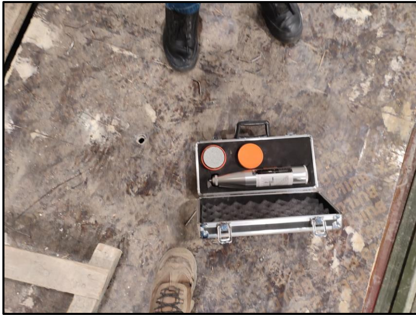
Fotografía 122. Equipo para el ensayo contiene esclerómetro y piedra áspera.
