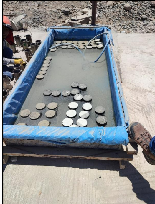
Fotografía 8. En la imagen se observa la condición en la que se cura las probetas cilíndricas en obra.
