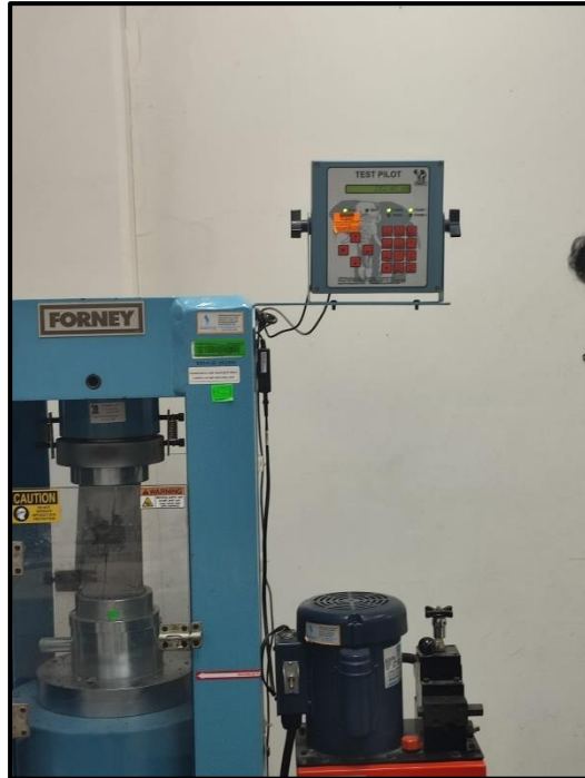
Fotografía 7. Se observa la realización del ensayo a compresión de probetas cilíndricas de concreto a los 7 días de la estructura que fue evaluada.
