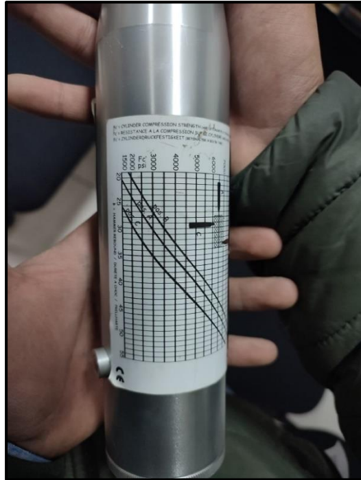
Fotografía 5. Se utilizó la tabla que se encuentra en el esclerómetro para el cálculo de la resistencia f_c , con el fin de obtener la resistencia en campo.
