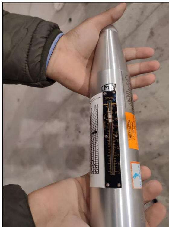
Fotografía 15. Lectura de disparo de esclerómetro y anotación.
