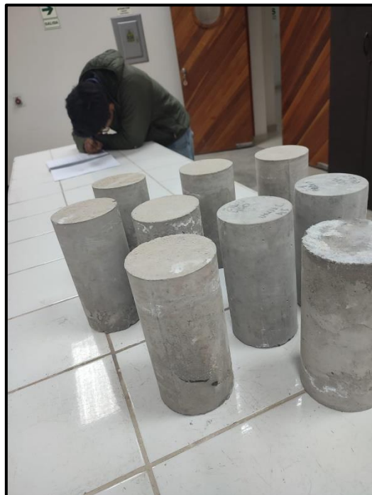
Fotografía 6. Se llevaron las muestras al laboratorio y se hizo la toma de datos de las probetas cilíndricas antes de realizar la rotura.
