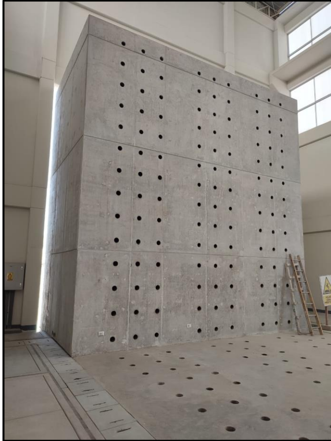
Fotografía 11. Muro de Reacción
