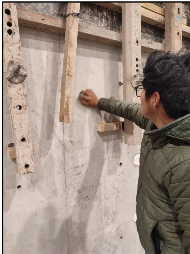
Fotografía 13. Preparación de la superficie de muestra usando la piedra áspera.
