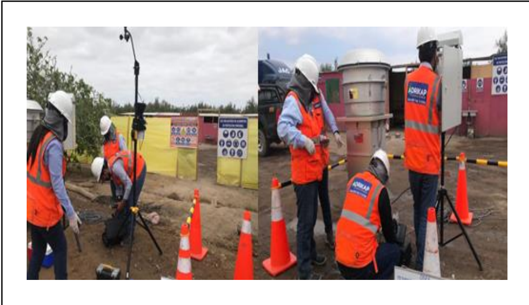
FOTO N° 3: MONITOREO DE CALIDAD DE AIRE ANTES DE LA EJECUCION DE LA OBRA
