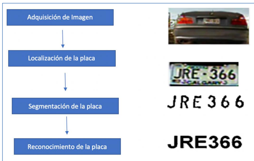
Estructura del prototipo de reconocimiento de placas
