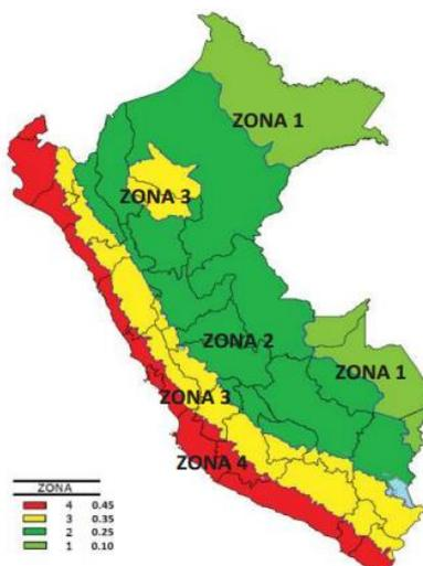
*Nota.* La figura muestra la zonificación sísmica en el mapa del Perú. Adaptado de la Norma Técnica E.030, 2018.
