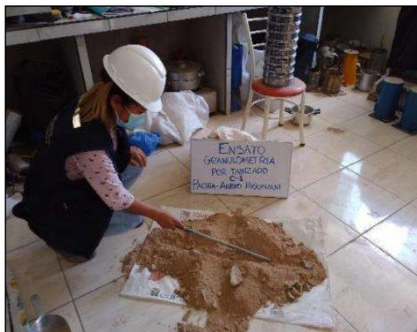
*Nota.* En la figura 14 se muestra el cuarteo respectivo de la muestra tomada en campo.
