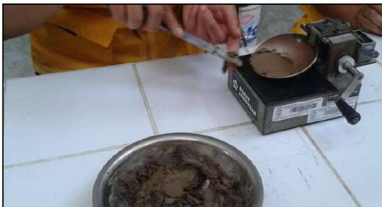
*Nota.* En la figura 15 la muestra es pasada por el tamiz 40, preparadas previamente con agua, se usó la espátula para lograr obtener una semi pasta homogénea y densa.
