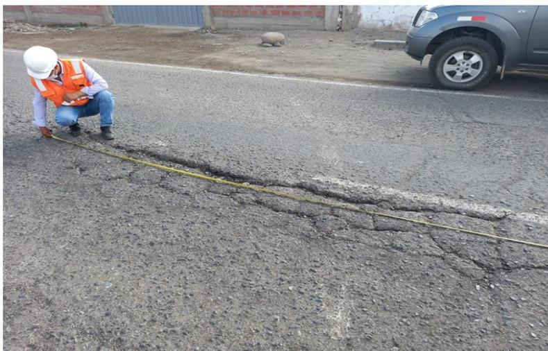
*Nota.* Distrito de Pocollay, en la Av. Circunvalación Sur, se visualiza formación de piel de cocodrilo de malla grande (> 0.5 m) sin material suelto. Asimismo, se visualiza deformación en la vía.
