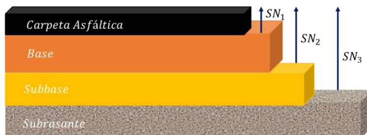
Determinamos el máximo espesor permisible de cada capa.
