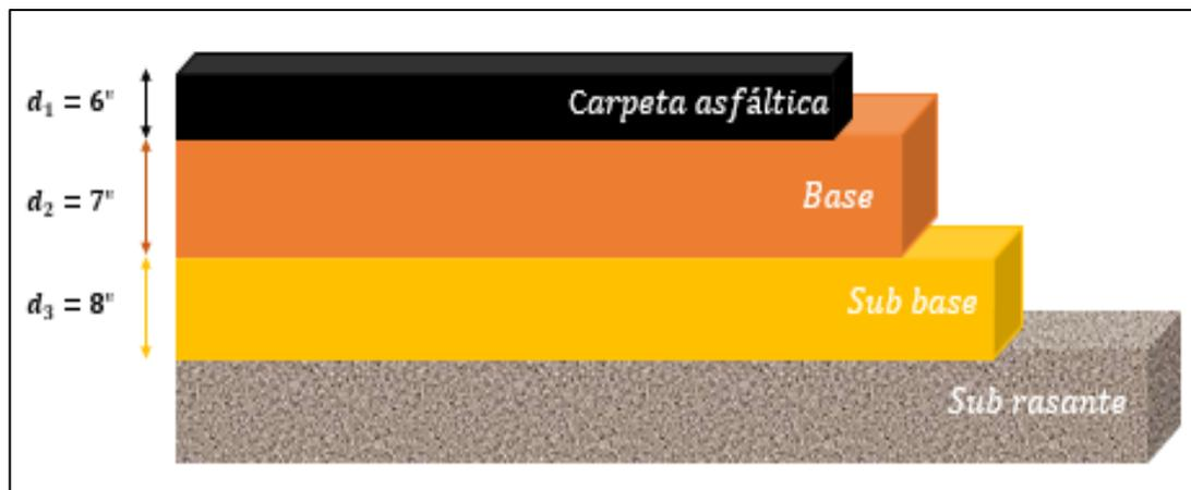
Los espesores de la Tabla 53 se obtuvieron con la SNR requerida (4,6) siendo menor que la SNR resultante (4,7), los siguientes espesores se obtienen debido al alto volumen de tráfico y por lo tanto son los más accesibles y económicos para el diseño.
