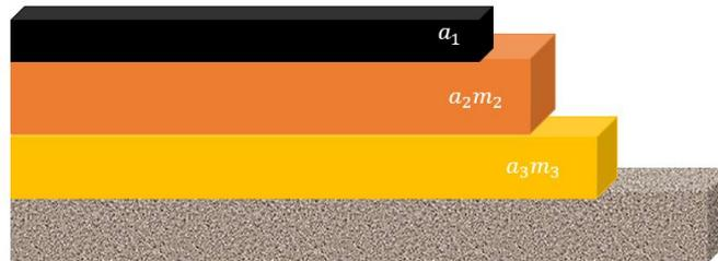
Con los datos anteriores podemos calcular el número estructural. Para calcularlo podemos despejarlo de la ecuación, mediante el nomograma del manual ASSHTO (Figura 47) u Excel.
