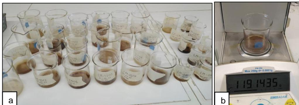
*Nota.* (a) Frascos con PAS después de estar secados en horno. (b) Pesado de PAS extraído en el lavado de las hojas.
