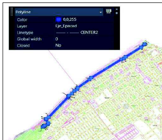
Figura 68 Trazo de Línea de Aducción
