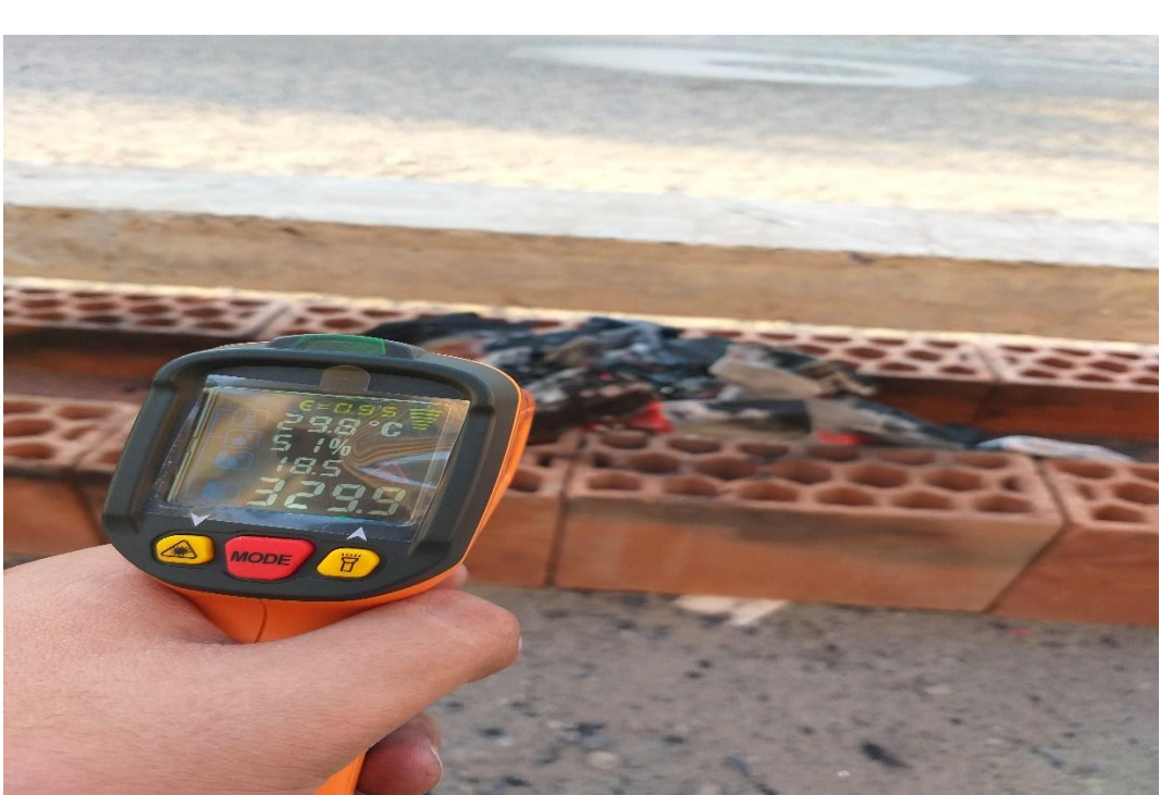
Medición de temperatura con pirómetro para el control del ensayo (329°C)
