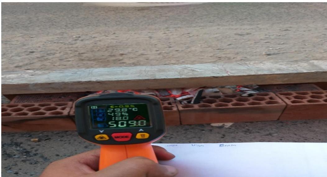
Medición de temperatura con pirómetro para el control del ensayo (509°C)
