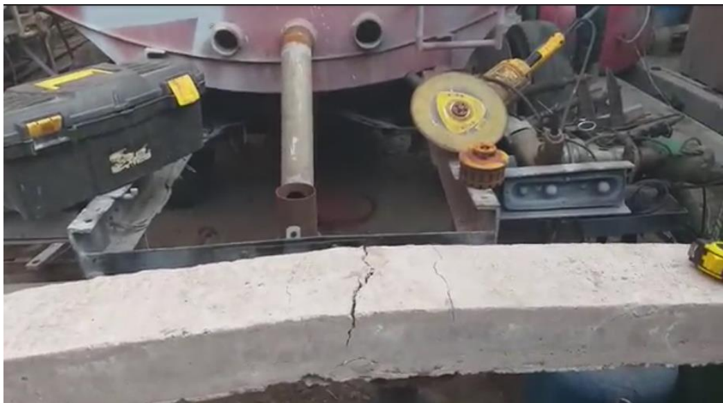
Viga sometida a ensayo a fin de determinar sus propiedades ante las cargas externas
