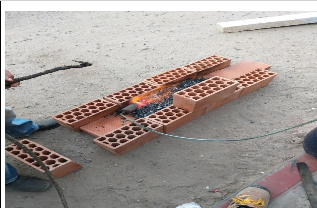
Preparación de candela para someter a la viga a altas temperaturas
