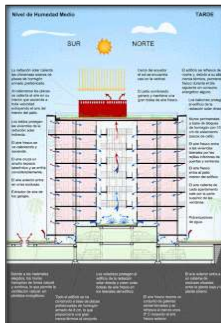
FIGURA N° 45: Sistemas de Transfección de aire fresco
