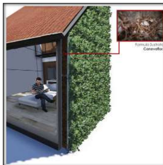
FIGURA N° 19: Muro verde térmico
